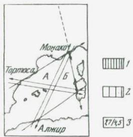
1 — зона пониженных скоростей; 2 — зона очень низких скоростей; 3 — скорости продольных (слева) и поперечных (справа) волн (км/с). На врезке стрелками показано направление распространения сейсмических волн
