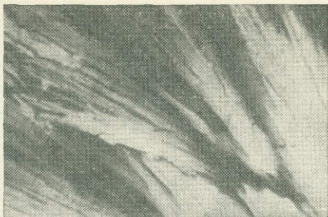
Рис. 6. Сноповый агрегат жадеитового пироксена. Обр. 29/1, увел. 80×.
