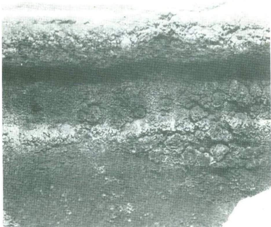
Фиг. 26. Строение поверхности пиритовой коры, нарастающей на стенки каптажного колодца скв. У-1 в 1976 г. Natur. вел.
