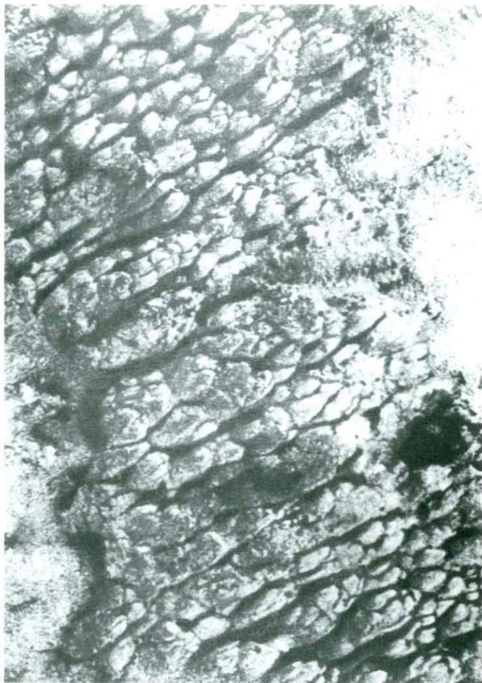
Асимметрично-почковидные образования гелеобразных сульфидов железа на поверхности пиритовой коры; каптажный колодец скв. У-1; период образования 2,5 месяца; натур. вел. (стрелкой указано направление силы тяжести)
