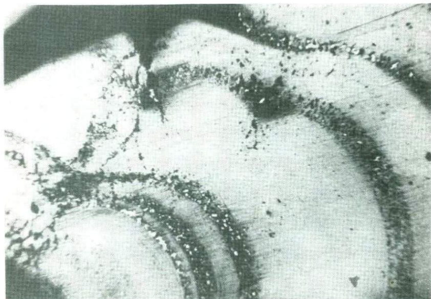
Фиг. 31. Микроолиты пирита (белое) в зонах пористого сфалерита (серое). Отраженный свет. Увел. 350
