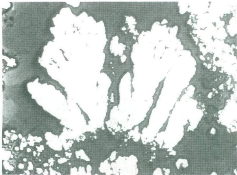
Фиг. 60. Столбчато-сегментационные образования пирита в призальбандовых зонах жильного выполнения второго цикла. Отраженный свет. Увел. 30
