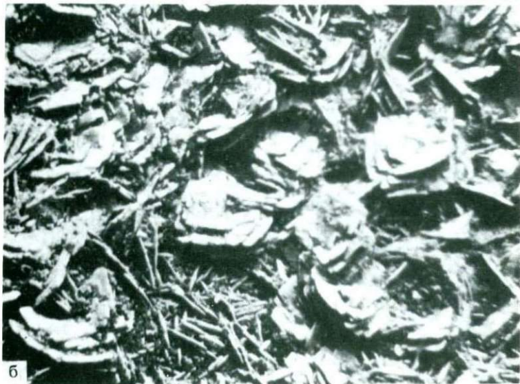
а — кристаллы оксалата меди; угольная реплика с частиц. Увел. 27 000; б — различно ориентированные сростки таблитчатых кристаллов атакамита; растровый электронный микроскоп; увел. 300
