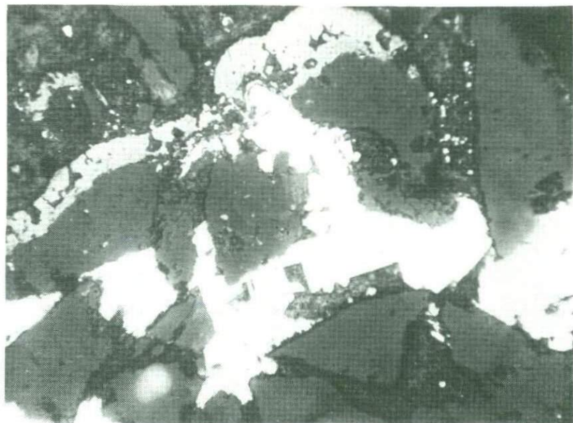
Фиг. 35. Галенит (белое), цементирующий терригенные частицы (темно-серое), перекрывающиеся корочкой метакolloидного сфалерита. Отраженный свет. Увел. 50
