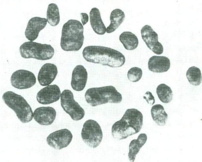
Фиг. 24. Оолиты пирита из открытого трубопровода. Натурал. вел.
