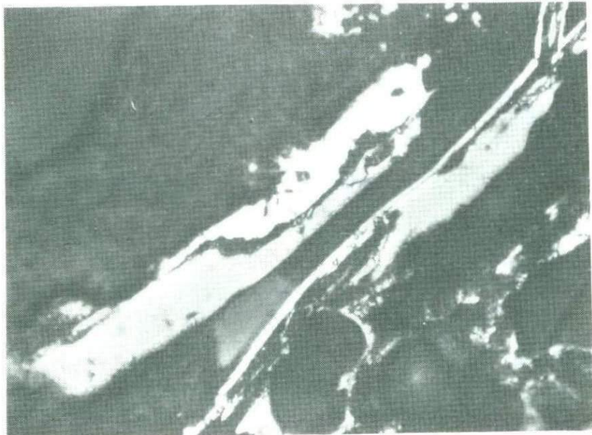
Фиг. 36. Пластинчатые кристаллы пирротина (светло-серое), частично замещенные пиритом (белое). Отраженный свет. Увел. 450
