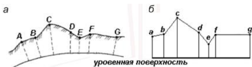
Рис. 27. Вертикальный разрез (а) и профиль (б) местности
