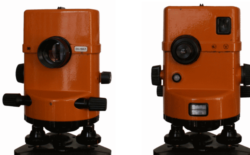
Рис. 65. Технический нивелир 2Н-10КЛ
