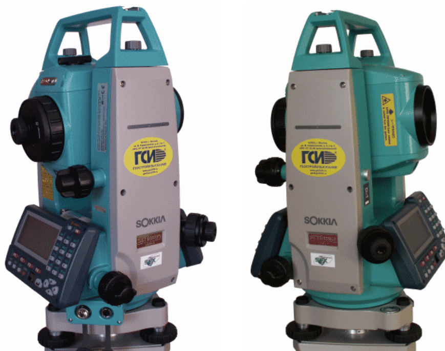
Рис. 76. Электронный тахеометр Sokkia SET 530RK3
