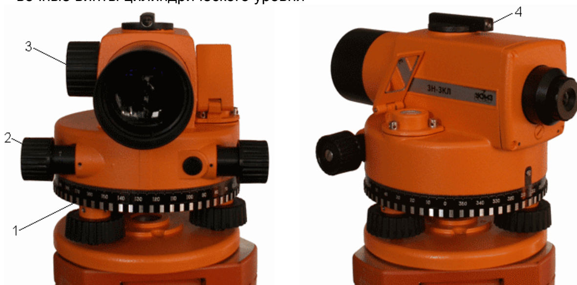
Рис. 64. Точный нивелир 3Н-3КЛ с компенсатором и лимбом: 1 – лимб; 2 – наводящий винт; 3 – кремальера; 4 – визир
