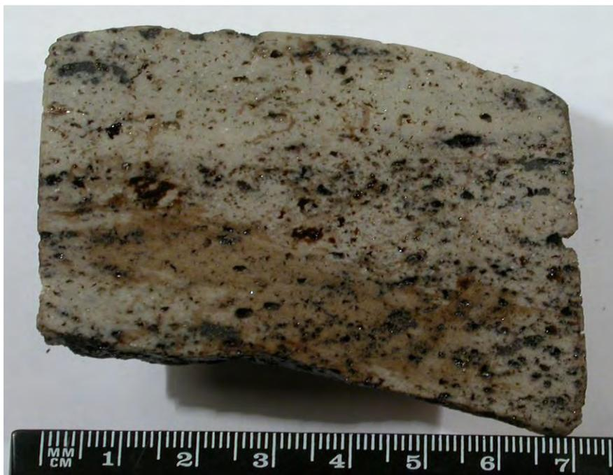
Фото 1. Образец доломита вторичного, неравномерно кавернозного, нефтебитумонасыщенного. Зона древнего водонефтяного контакта.
