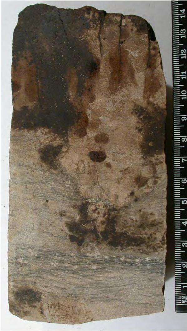
Фото 1. Образец. Субвертикальные открытые несквозные трещины в слабо неравномерно нефтенасыщенном биокластово-фитозоогенном известняке на границе с биокластово-фитогенным известняком.
