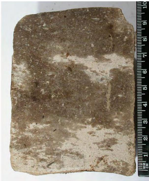
Фото 1. Образец известняка биокластово-фитозоогенного, неравномерно полосчато нефтенасыщенного.
