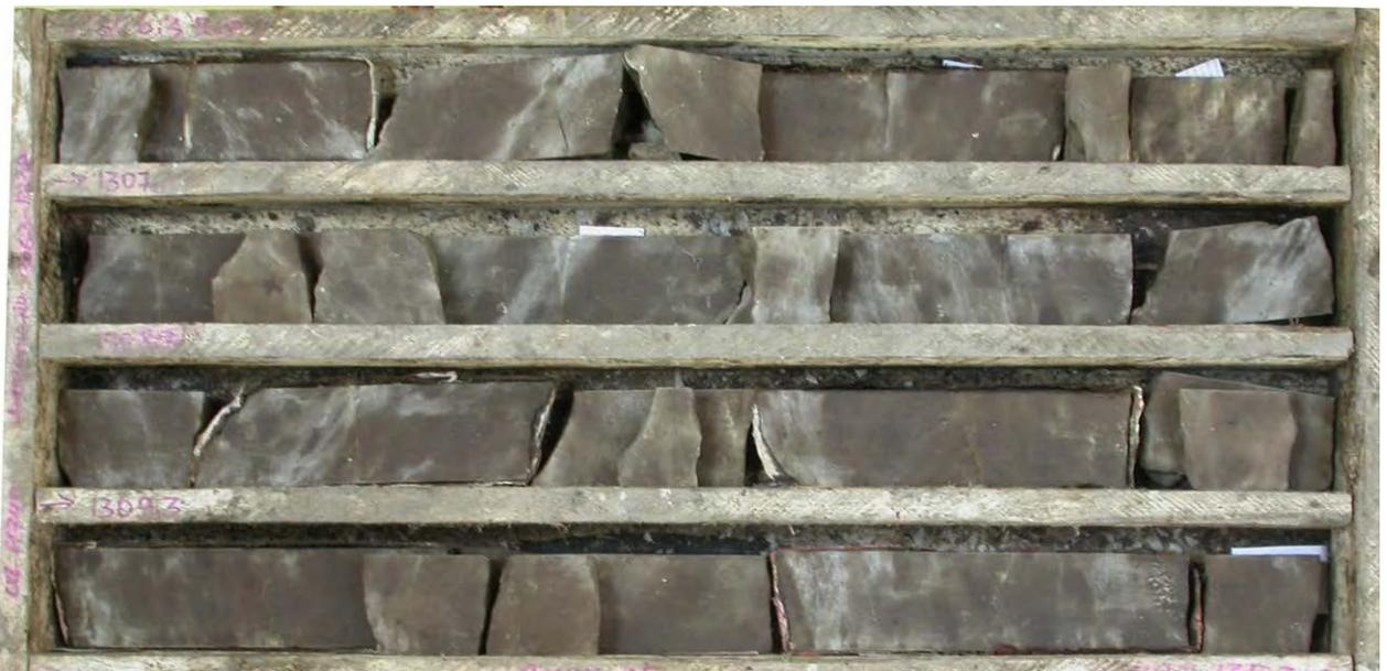
Фото 2. Неравномерно нефтенасыщенный керн. Коллектор порового типа. Непромышленная залежь. Глубина 1306,6-1310,3 м, увеличивается слева направо и сверху вниз. Черепетский горизонт. Онбийское месторождение Скважина 11749. Вынос керна 100%. Длина ящика 1 м.
