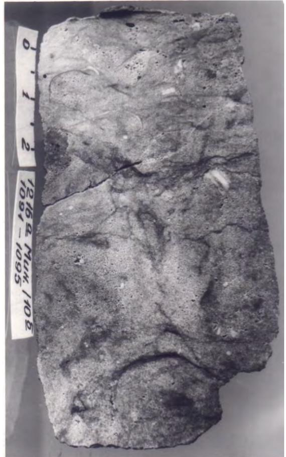
Фото 2. Образец. Наклонная трещинка в биокластово-фитозоогенном известняке. Известняк слабо неравномерно нефтенасыщен.
