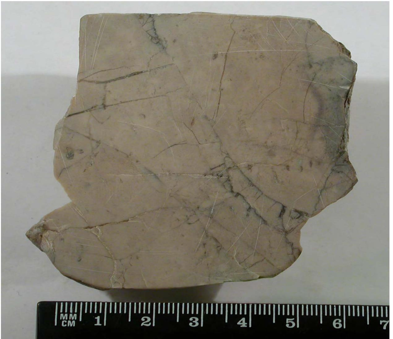
Фото 1. Образец известняка пелитоморфного, плотного, трещиноватого.
