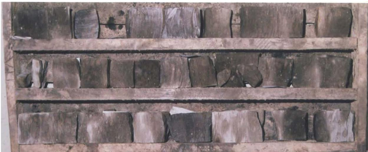
Фото 2. Неравномерно нефтенасыщенный керн. Коллектор порового типа. Непромышленная залежь. Кизеловский горизонт. Демкинское месторождение Скважина 1166. Глубина 1290,6-1293,6 м, увеличивается слева направо и сверху вниз. Вынос керна 100%. Длина ящика 1 м.
