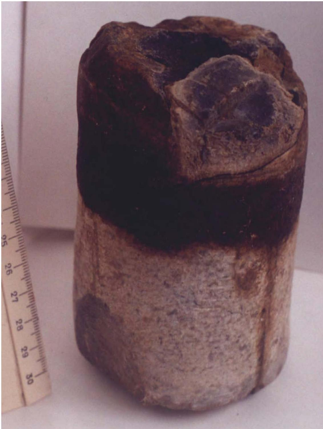
Фото. 1. Образец. Стяжение темно-серого кремня на границе биокластово-фитозоогенного (внизу) и биокластово-зоогенного (вверху) известняков. Известняк биокластово-зоогенный равномерно нефтенасыщен. Видна вертикальная трещинка в биокластово-фитозоогенном известняке.
