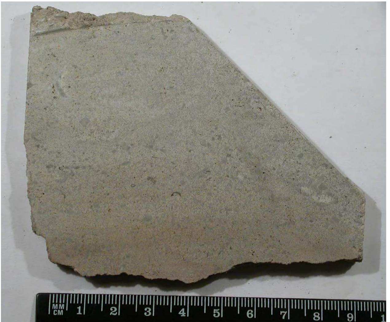
Фото 1. Образец биокластово-зоогенного известняка. Однородная текстура. Образец после экстракции углеводов.
