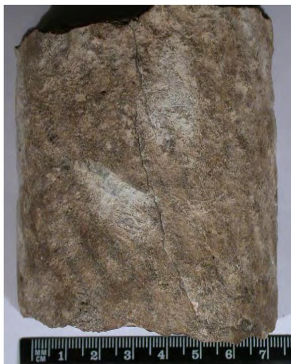
Фото 1. Образец. Прожилково-гнездовидные выделения агрегатов ангидрита (светлое) в биокластово-зоогенном известняке. Зона древнего водонефтяного контакта. Упинский горизонт. Онбийское месторождение. Скв. 11845. Гл. 1174,2 м. Обр. 119.
