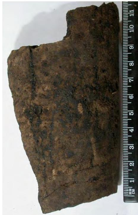
б) Субвертикальная и субгоризонтальная трещиноватость
