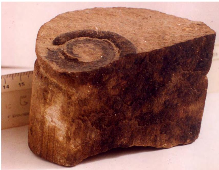
Фото. 1. Образец. Поверхность вертикальной трещины в неравномерно нефтенасыщенном биокластово-фитозоогенном известняке. Поверхность трещины мелкоступчатая. На вертикальном искусственном сколе видна раковина гастроподы.
