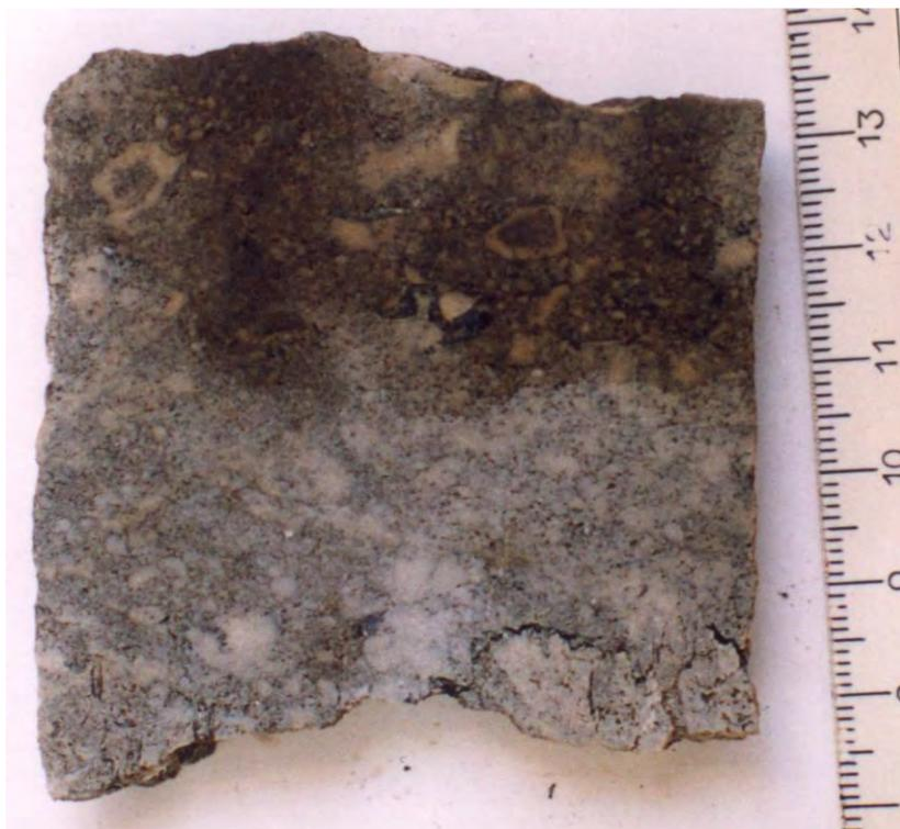
Фото. 1. Образец известняка биокластово-зоогенного с неравномерной кавернозностью и битумонасыщенностью. Зона современного водонефтяного контакта.
