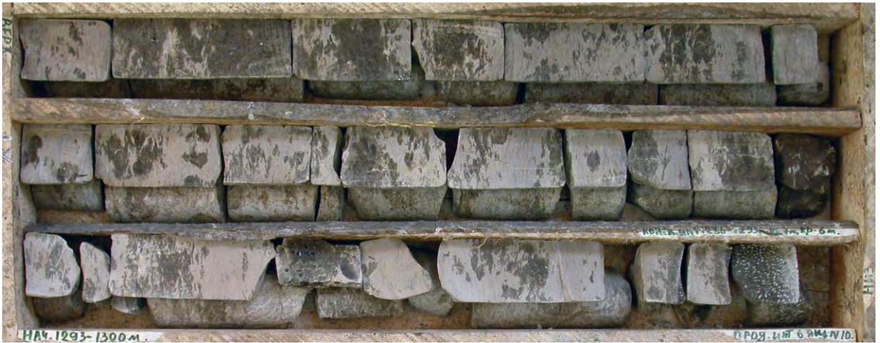
Фото 1. Неравномерно нефтенасыщенный керн. Коллектор порового типа. Непромышленная залежь. Глубина 1291-1294 м, увеличивается слева направо и сверху вниз. Черепетский горизонт. Демкинское месторождение Скважина 1267. Вынос керна 100%. Длина ящика 1 м.
