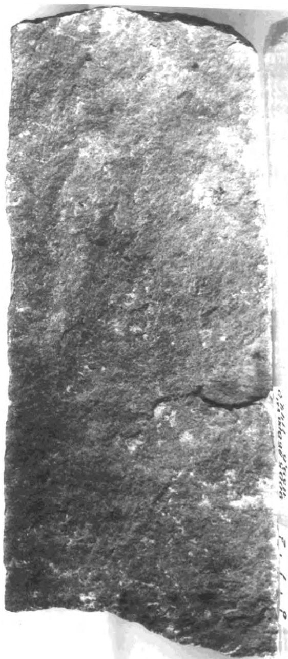
Фото 2. Образец. Стенка эффективной вертикальной трещины в нефтенасыщенном биокластово-фитозоогенном известняке.
