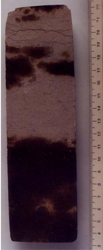
Фото 1. Образец с литологической неоднородностью и неоднородностью по флюидонасыщенности. Пласт V<sub>IV</sub>. Равномерная нефтенасыщенность – биокластово-зоогенный известняк (нижняя часть образца). Без нефти и пятнистая нефтенасыщенность – биокластово-фитогенные и биокластово-фитозоогенные известняки (средняя и верхняя части образца).
