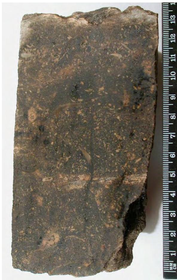
Фото 2. Образец. Субвертикальная открытая несквозная трещина в слабо неравномерно нефтенасыщенном биокластово-фитогенном известняке.
