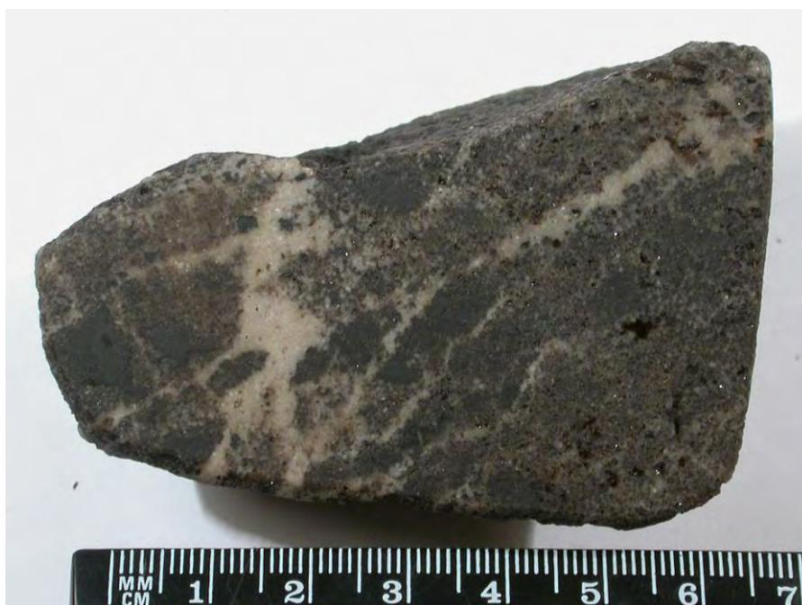
Фото 2. Образец доломита вторичного, плотного (светлое) в неравномерно кавернозном биокластово-зоогенном известняке (темное). Зона древнего водонефтяного контакта.
