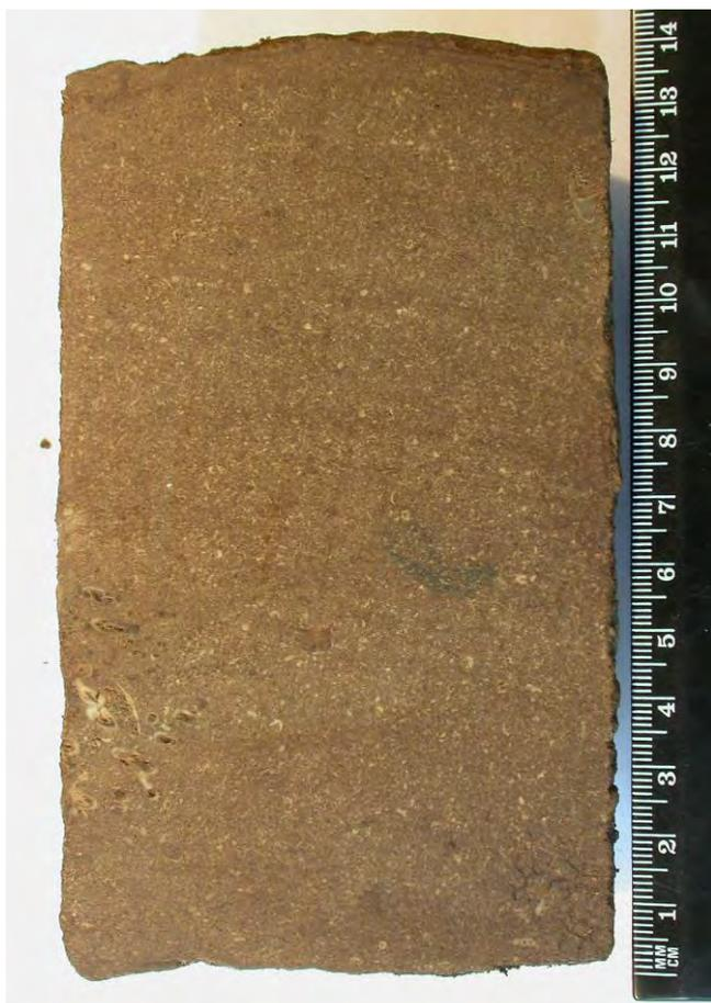
Фото 1. Образец известняка биокластово-зоогенного. Коллектор кавернозного типа. Равномерная нефтенасыщенность.
