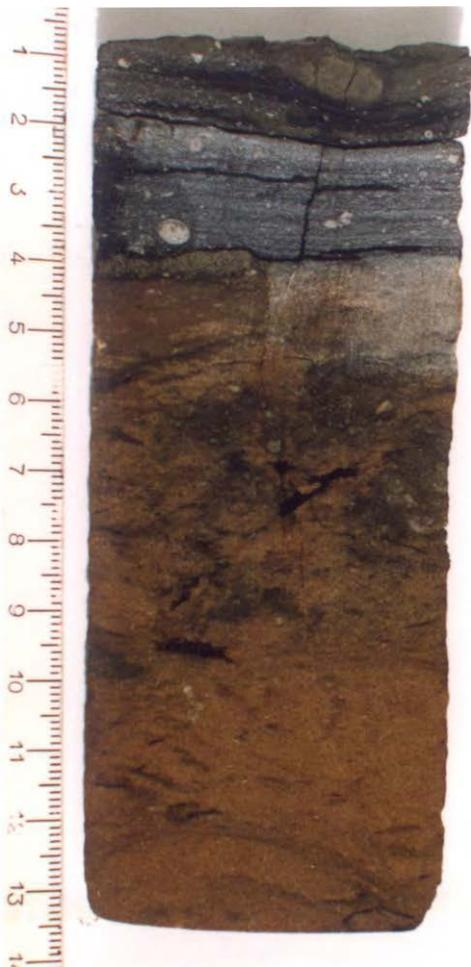
Фото. 2. Образец. Несогласная граница пород визейского и турнейского ярусов. Визейские отложения представлены известково-углистым аргиллитом с обломками известняков (вверху). Турнейские отложения (кровельная часть кизеловского горизонта) представлены плотными биокластово-фитогенными известняками со слоями углисто-терригенного материала (внизу). Верхнюю часть образца рассекают субвертикальные трещинки.
