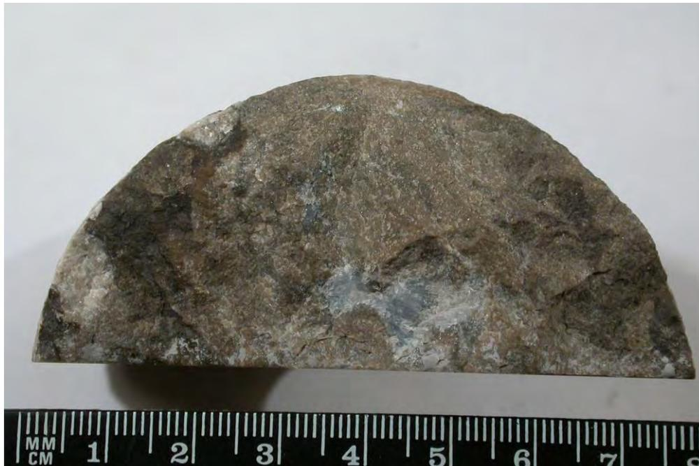
Фото 2. Образец. Гнездовидное выделение ангидрита (серое) в биокластово-фитогенном известняке. Зона древнего водонефтяного контакта.
