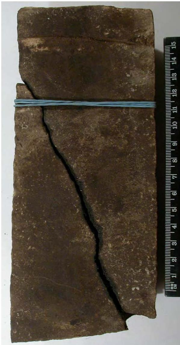
Фото 1. Образец. Субвертикальная открытая трещина в нефтенасыщенном биокластово-зоогенном известняке.
