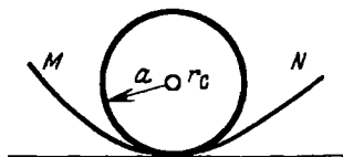
Рис. 4.5. Схема пласта с контурами питания различной формы
