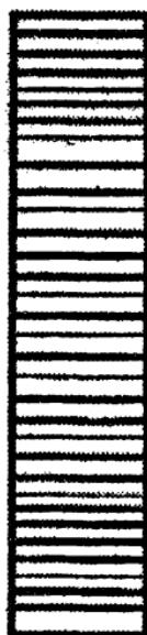
Рис.23. Двойниковая штриховка на плоскости спайности (100) антимонита
