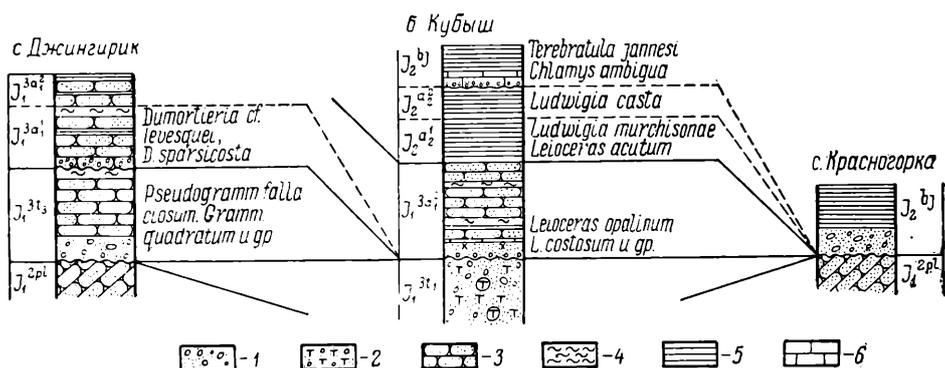
Рис. 2. Схема изменения отложений верхнего лйаса и средней юры по р. Кубань. 1 — гравелиты; 2 — туфобрекчии и туфопесчаники; 3 — песчаники; 4 — алевролиты; 5 — аргиллиты; 6 — известняки.
