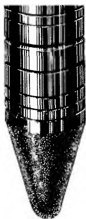
Рис. 5.17. Конструкция кольцевого пенетратора с кольцевым нагревателем.
