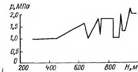
Рис. 2.17. Изменение давления пены с глубиной скважины.
