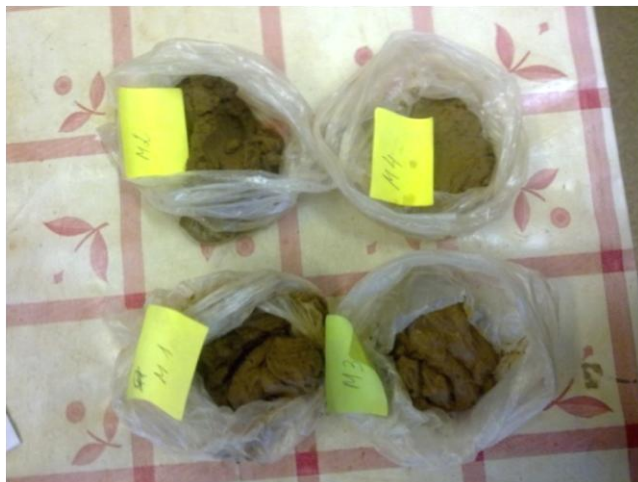
Рис. 2.1. Пасты для приготовления модельных грунтов с весовой влажностью W=20\%
