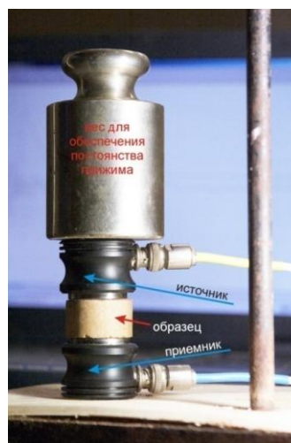
Рис. 2.10. Взаимное расположение датчиков и образца
