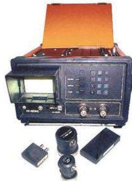
Рис. 2.8. Внешний вид дефектоскопа УД2Н-П
