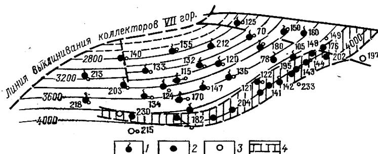
Рис. 28. Месторождение Карадаг (структурата по кровле VII горизонта)
