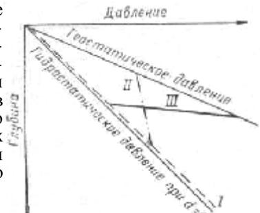
Рис. 83. Три основные закономерности изменения пластовых давлений с глубиной.
