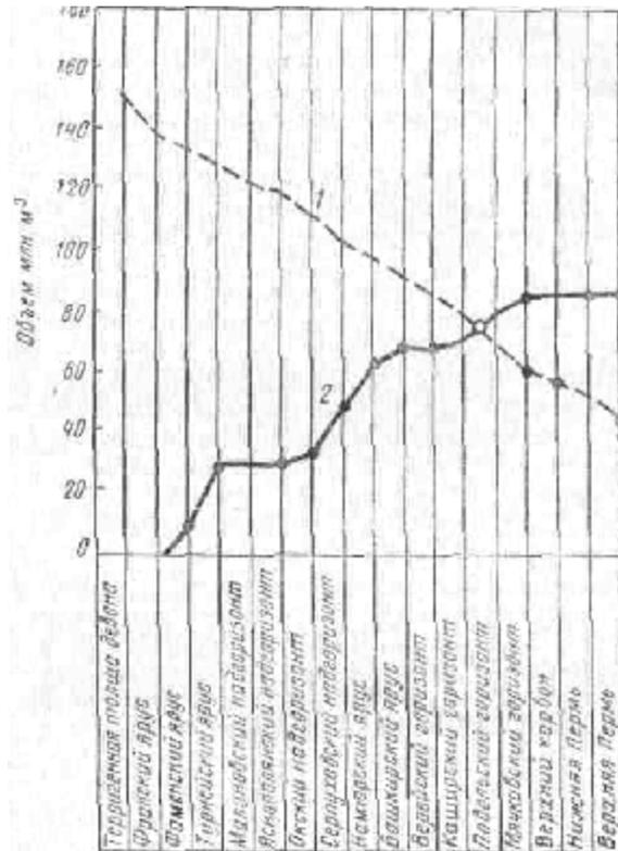
Рис. 153. Диаграмма для определения времени заполнения ловушки (по В. А. Кирову, 1964).
