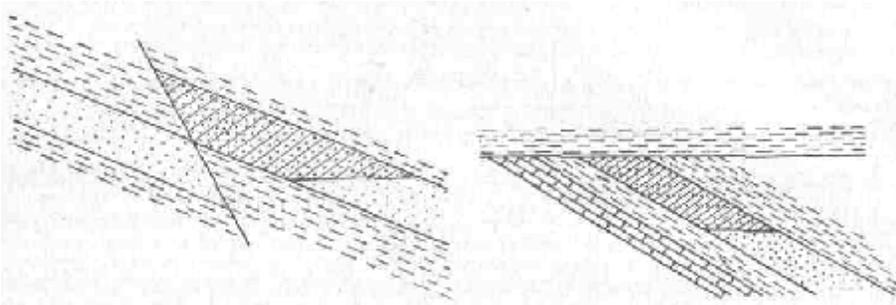
Рис. 86. Принципиальная схема пластовой, тектонически экранированной залежи.
