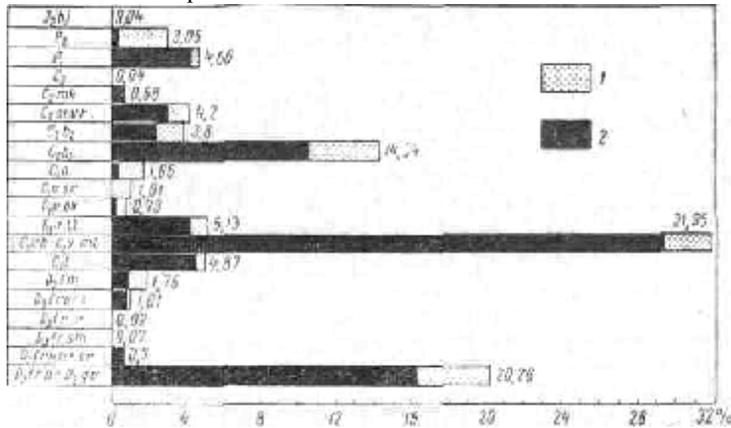
Рис. 157. Распределение запасов нефти и газа по разрезу палеозойских отложений южных районов Волго-Уральской нефтегазо-носной области в % (по С. П. Максиму, 1964).
