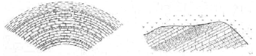
Рис. 48. Схема однородного массивного резервуара. Рис. 49. Схема неоднородного массивного резервуара.
