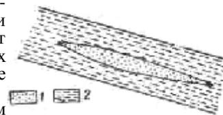
Рис. 51. Принципиальная схема резервуара, ограниченного со всех сторон плохо проницаемыми породами. 1 — песок; 2 — глина.
