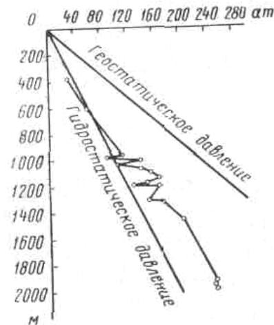
Рис. 80. Фактическое изменение величины пластового давления в зависимости от глубины в залежении Челекен (по Б. А. Тхостову).
