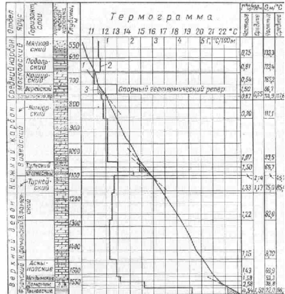
Рис. 84. Геотермическая характеристика разреза скв. 166 Тумазинского района (по Д. И. Дьяконову).
