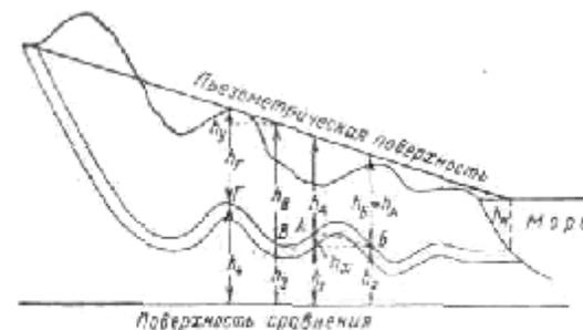
Рис. 72. Сопоставление пластовых и приведенных давлений при наклонном положении пьезометрической поверхности.
