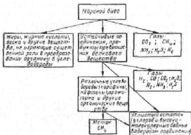
Рис. 144. Схема образования углеводородов из белков.
