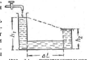
Рис. 42. Экспериментальная установка для изучения коэффициента фильтрации.
