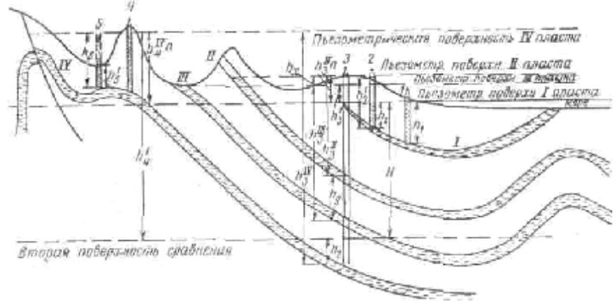
рис. 69. Схема гидростатических давлений и пьезометрических поверхностей.
