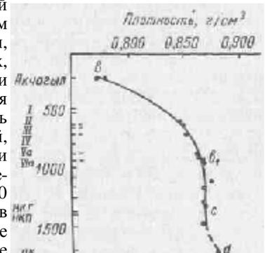
Рис. 134. Кривая зависимости плотности нефти от глубины ее залегания по разрезу (район Сураханов).
