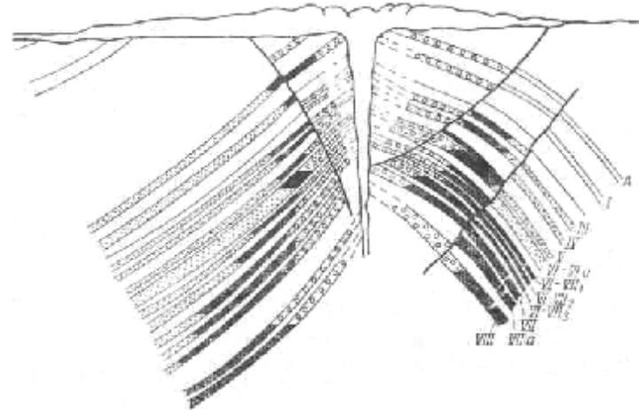
Рис. 113. Схема пластовых залежей, разбитых на блоки в разрезе
