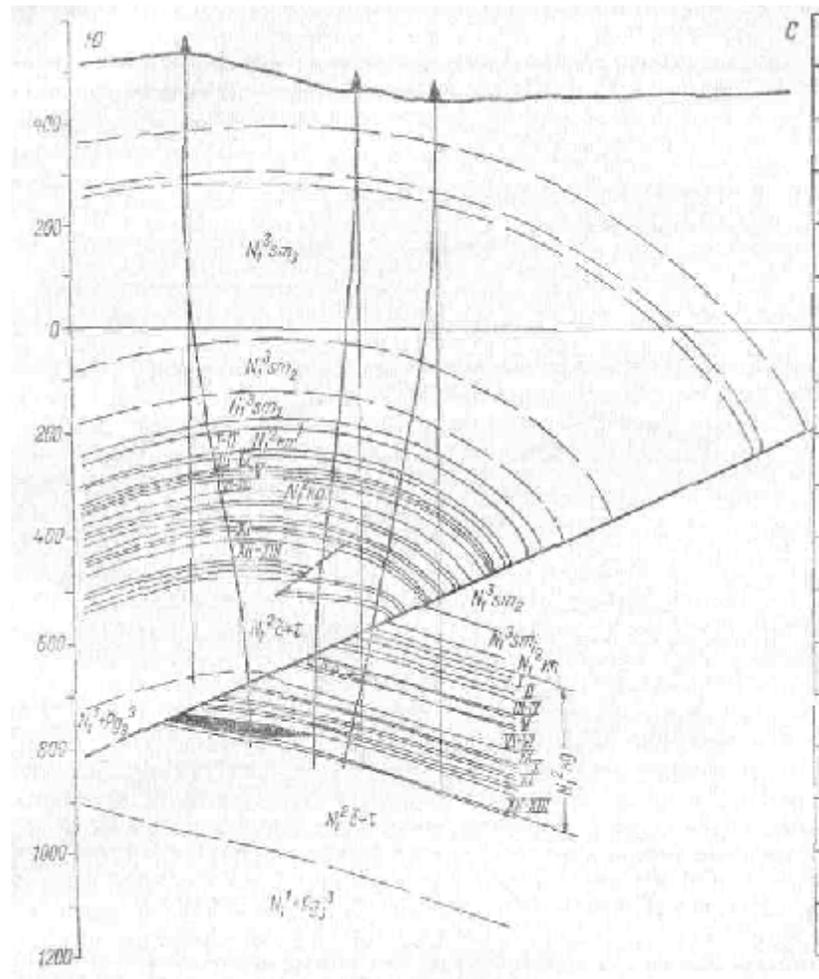
Рис. 107. Профильный геологический разрез месторождения Малгобек, северный поднадвиг (по В. П. Куцеву и В. П. Крымову).
