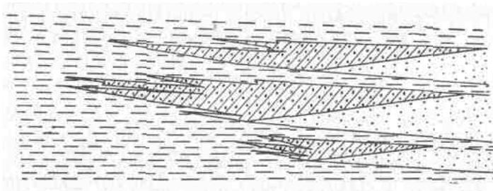
Рис. 88. Принципиальная схема пластовых, литологически экранированных залежей.
