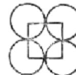
Рис. 34. Наименее плотное расположение зерен. Теоретический объем пор 47,6%.
