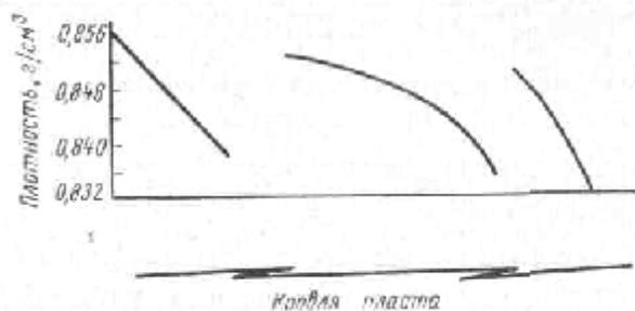
Рис 105 Кривая зависимости плотности нефти III пласта свиты «в» от глубины ее залегания, месторождение Махачкала.
