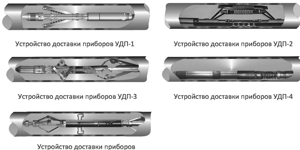
Рис. 6.1 Модификаций устройств доставки приборов в горизонтальную часть ствола работающей скважины
