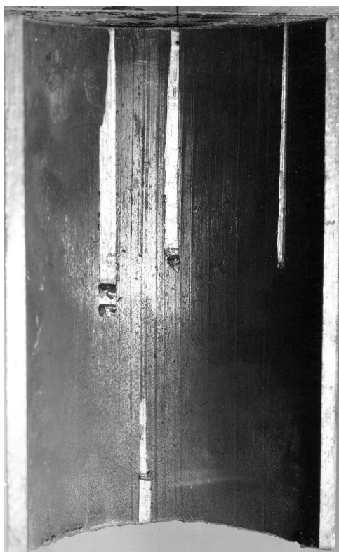
Рис. 4.4 Порезы и иссечение внутренней поверхности труб резцами долот при разбурировании цементных стаканов
