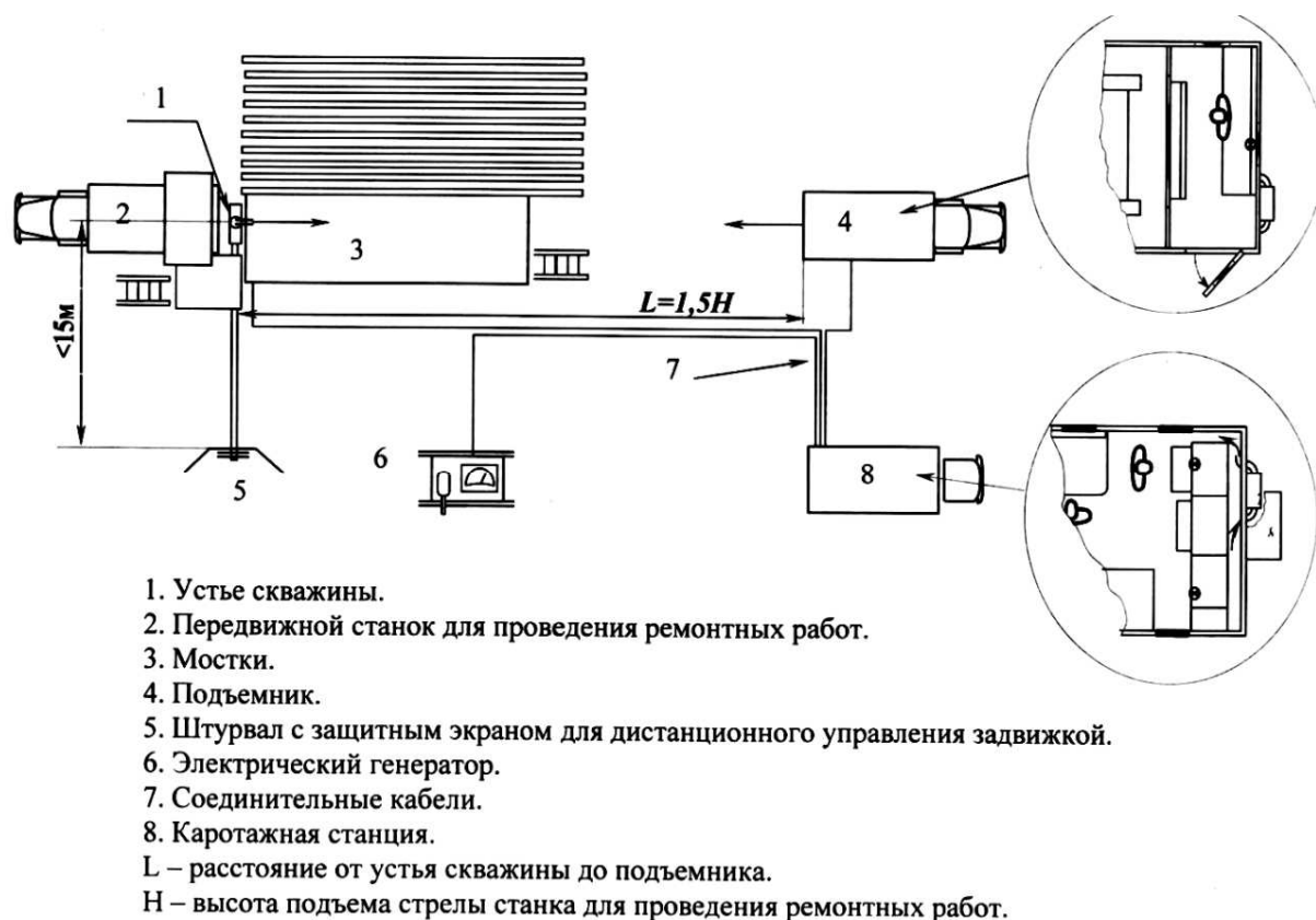
Рис. 2.4. Схема расположения механизмов и узлов во время проведения каротажных работ
