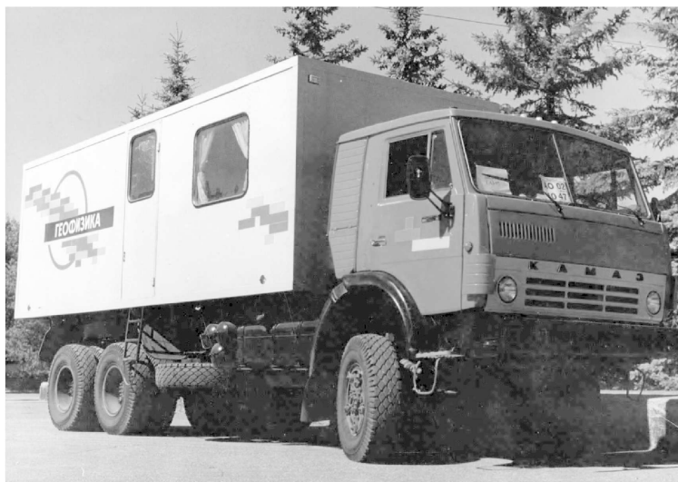
Рис. 2.3. Современная каротажная станция, выпускаемая отечественной промышленностью
