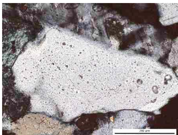
Рис. 4.11. Укрупнение зерен кварца при регенерации. А, В – николи ||, Б,Г – николи ×. Скв. Ванкорская-11, яковлевская свита, гл. 1685 м
