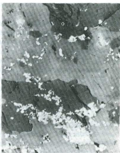
Рис.6. Скопление зерен и агрегатов уранинита (белый) в ортите (темно-серый) и апатите - светло-серый. Микрофото полир.шлифа. Ув.200.
