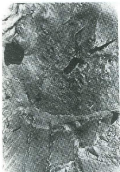
Рис. 3. Браннерит волокнистой структуры. Промежутки между блоками выполнены аморфным веществом. Электронно-микроскопический снимок угольной реплики со скола массивного образца. Ув. 10000.
