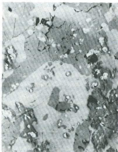
Рис.5. Уранинит в ортите - серый, светло-серый - апатит содержит включения уранинита в тех местах, где наблюдается ортит. Микрофото пол. шлифа. Ув. 200.
