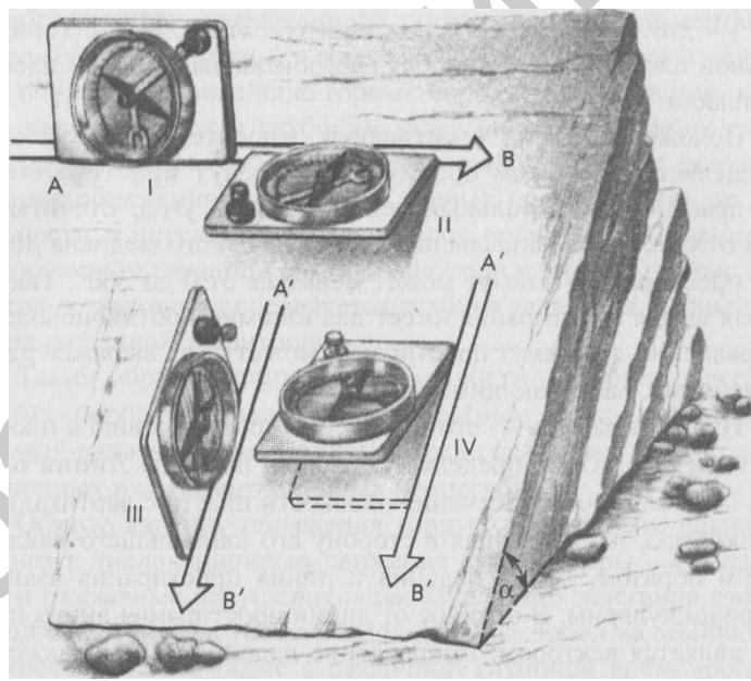
Рис.1.74.Элементы залегания пласта и их определение с помощью горного компаса: АВ — линия простириания; А'В' — линии падения; а— угол падения; I— нахождение линии простириания; II — определение азимута простириания; III — определение угла падения; IV — определение азимута падения.
