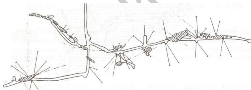
Рис. 2.13. Система опережающей эксплуатационной разведки линзообразных рудных тел веерами подземных горизонтальных скважин
