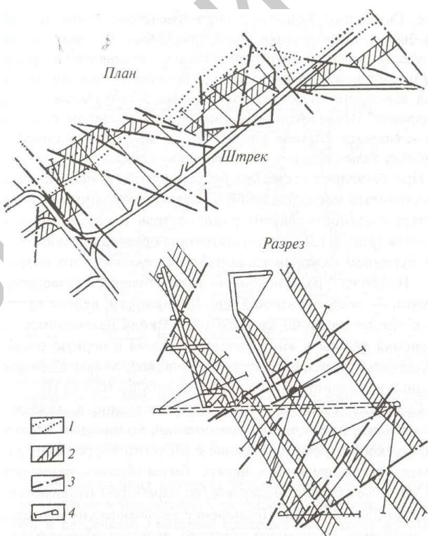
Рис. 2.15. Схема эксплуатационной разведки рудных тел Высокогорского скарново-магнетитового месторождения. (Россия) Контуры рудного тела по данным: 1 - детальной разведки. 2 - эксплуатационной разведки; 3 - тектонические нарушения; 4 - скважины эксплуатационной разведки
