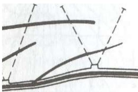
Рис. 2.12. Прослеживание апофиз и поиски сближенных рудных тел горизонтальными скважинами.
