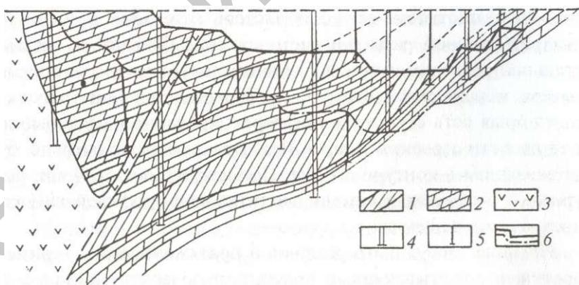
Рис. 2.8. Схема эксплуатационной разведки пластиобразных залежей «бакальского» типа. По М.Н. Альбову и А.М. Быбочкину. 1 - рудные тела; 2 - доломиты и известняки; 3 - диабазы; 4, 5 - скважины: 4 - детальной разведки, 5 - эксплуатационной разведки; 6 - положения контура карьера по мере углубления добычных работ
