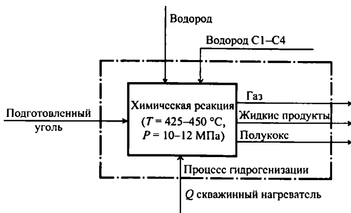
Рис. 2.13 Схема процесса гидрогенизации
