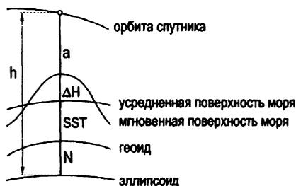
Рис. 7.7: Спутниковая альтиметрия
