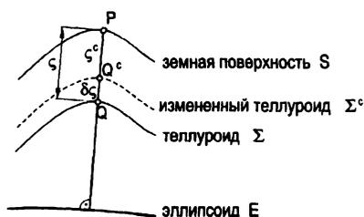
Рис. 8.9: Теллуroid до и после редукиции силы тяжести,  $\Sigma$  и  $\Sigma^c$ , соответственно
