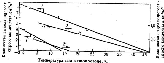
Рис. II.13. Зависимость количества выделяющегося из газа конденсата от температур сепарации и газопровода.
