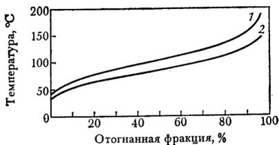
Рис. 1.7. Зависимость фракционного состава конденсата от дебита газа скважины.
