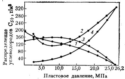
Рис. IV.23. Распределение углеводородов C<sub>5+</sub> при разработке на истощение залежи БН<sub>11</sub> Западно-Таркосалинского месторождения.
