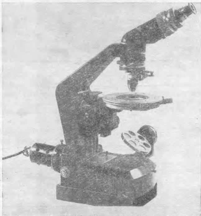
Рис. 4. Поворотный фильтр-монохроматор «Спектр» на микроскопе МИН-8
