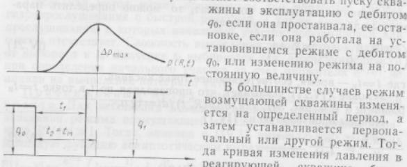
Рис. 35. Изменение давления в реагирующей скважине после остановки и пуска возмущающей скважины
