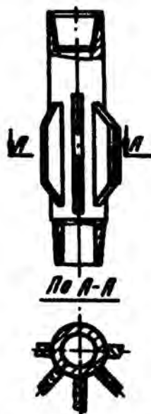
Рисунок 5.41 – Эксцентрик для поперечного расхаживания колонны
