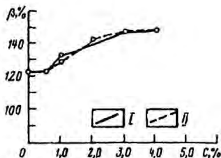
Рисунок 4.4 – Влияние массовой доли S комплексов (НТФ и ОЭДФ) в водном растворе поташа на коэффициент восстановления проницаемости: I – обработка раствора НТФ; II – обработка раствора ОЭДФ
