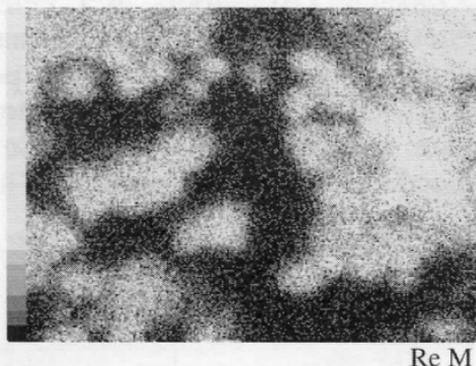
**Рис. 45.** “Луна-16”. Сростки перхлората калия (более темный) с самородным рением, отраженные электроны и карты распределения кислорода, калия и рения соответственно при ускоряющем напряжении 8 кВ
