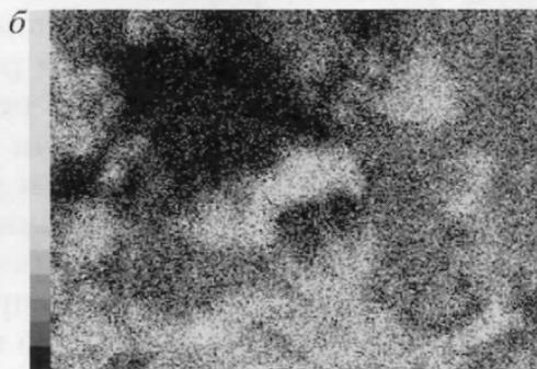
**Рис. 42.** “Луна-16”. Сросток оксида рения (более темный) с самородным рением (а), отраженные электроны; карта распределения рения и кислорода (б); рентгеновский спектр оксида рения (в)
