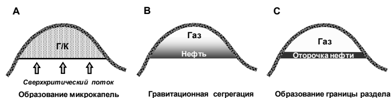
Рис. 1. Этапы образование нефтяной оторочки
