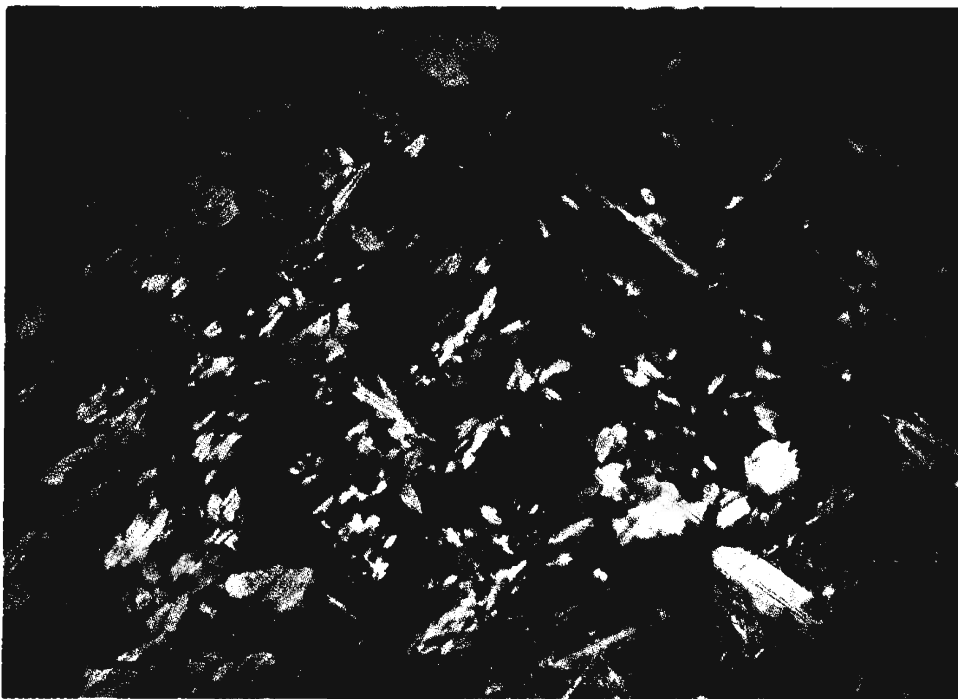
Рис 50 Тальк-клинохризотилловые метасоматиты процилиговой формации, заместившие антигоритовые серпентиниты (Карабашский массив, скважина № 396, глубина 70 м). Шлиф, николи × Ширина поля зрения 3 мм
