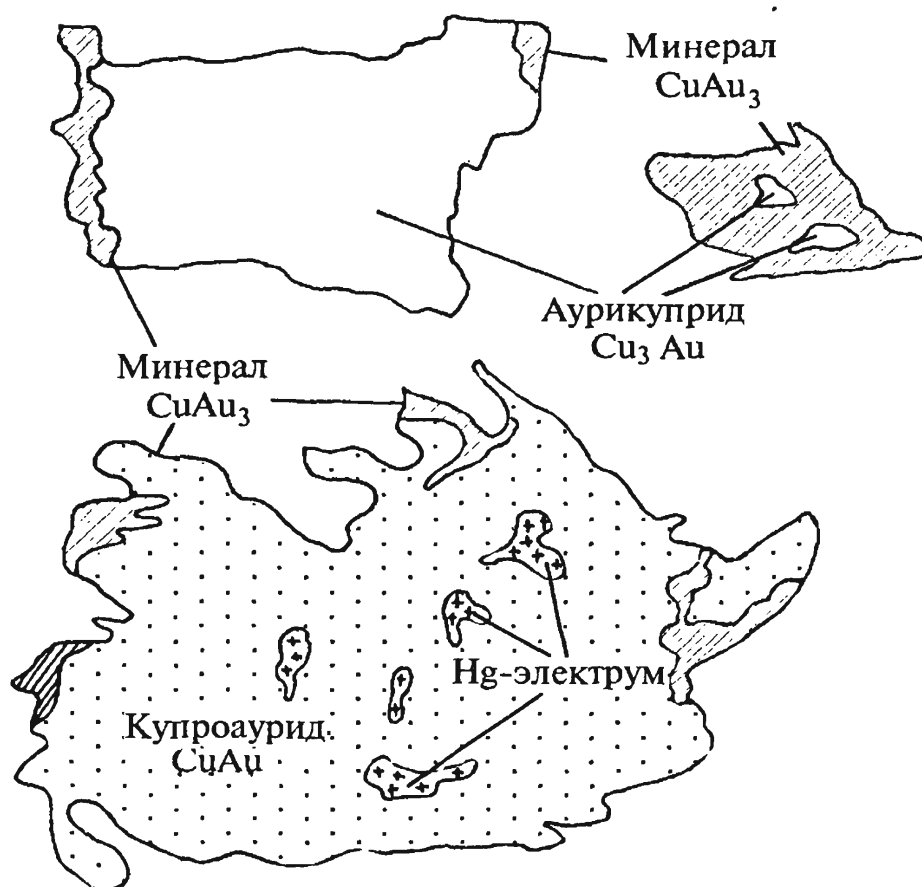
Рис. 80. Аурикуприд и купроаурид с включениями ртутистого электрума, окруженные каймами минерала \text{CuAu}_3 (Западное рудное тело). Зарисовка аншлифа. Ширина поля зрения 0,5 мм
