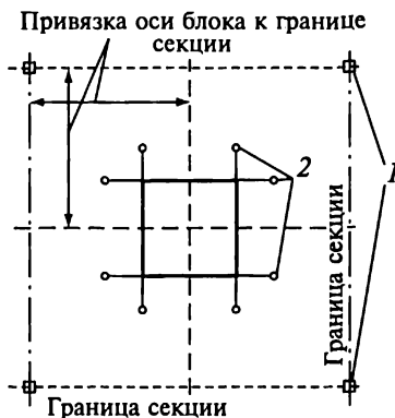
Рис. 26.5. Схема разбивки осей блока плотины: 1 — угловые знаки; 2 — знаки выноски
