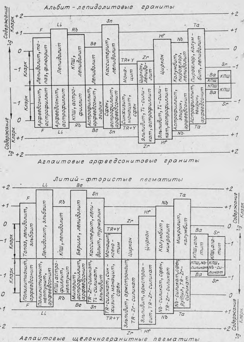
Рис. 78. Степень концентрации редких элементов в редкометалльных гранитах и пегматитах (определяется как десятичный логарифм отношения концентрации элемента в породе к кларку в гранитах) и минералы-носители редких элементов в этих породах.
