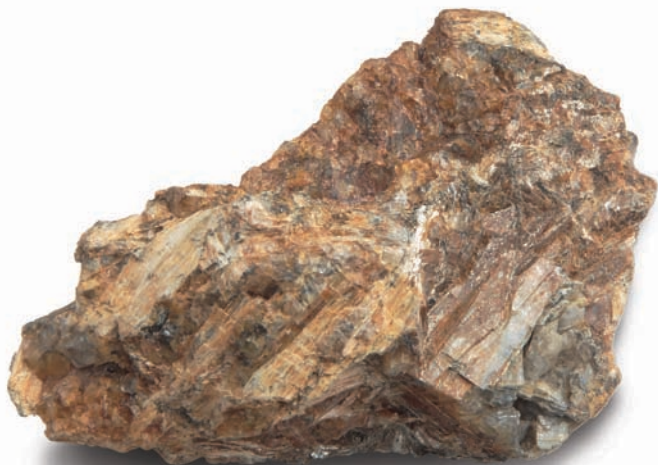
1. Силлиманит, кианит в кристаллическом сланце (образец 7х3 см)
