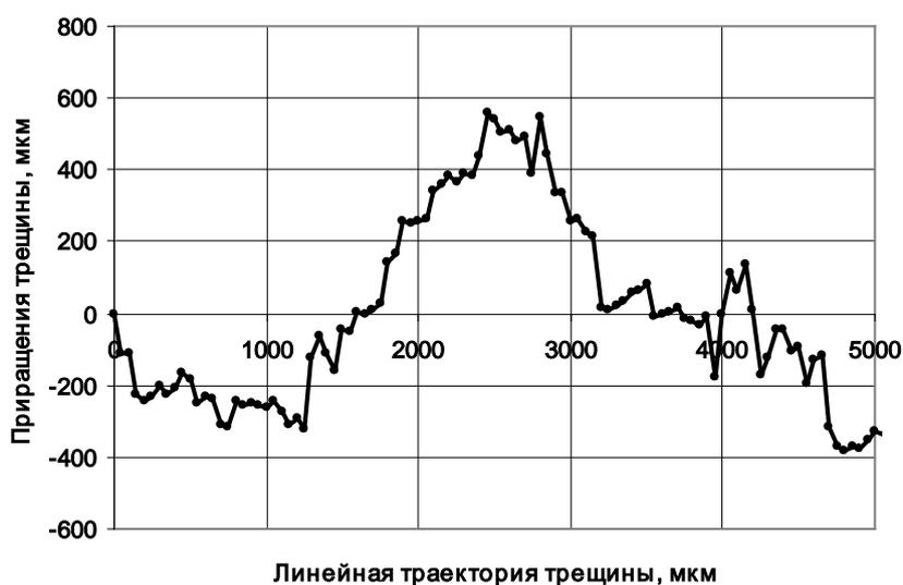
Рис. 8.1. Результаты реализации программы моделирования приращения трещины
