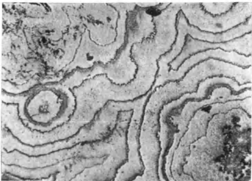
Рис. 52. Колломорфные зональные выделения голландита (светло-серое) и криптомелана (серое) на стенках пор и крупных пустот в базальтовой лаве. Мартиросское рудопоявление. АрмССР. Аншлиф. Ув. 100, без анализатора. По П. Ф. Андрущенко
