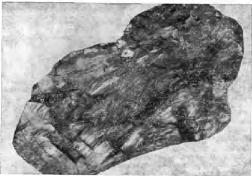
Рис. 45. Массивные сферолитовые агрегаты грубокристаллического тодорокита. Формации Эль-Кобре. Месторождение Чарко-Редондо. Куба, пров. Орьенте. Ув. 1. По Е. А. Соколовой
