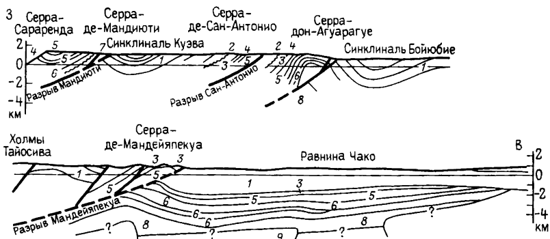
Рис. 49. Схематический поперечный геологический разрез через Центрально-предандийский бассейн по линии Серра-Сараренда — равнина Чако.
