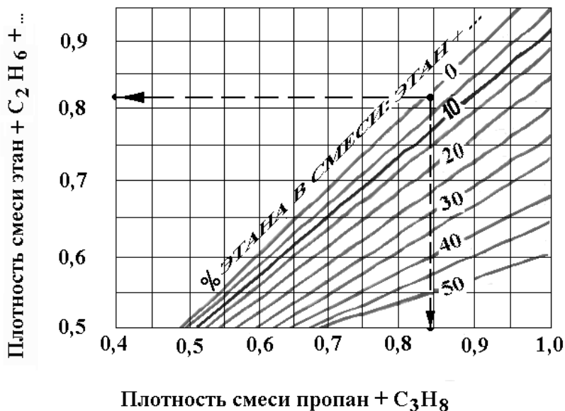
Рис. 4.5. Определение плотности смеси этан+высшие при различном содержании этана в смеси
