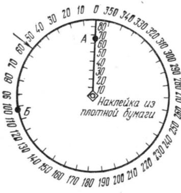
Рис. 16. Восковка, наложенная на сетку. При данном положении восковки нанесен замер поверхности трещин с азимутом падения 50° 60° (точка А). Точка Б отвечает замеру; азимут простириания 223° 90°
