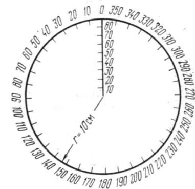
Рис. 14. Сетка для нанесения замеров
