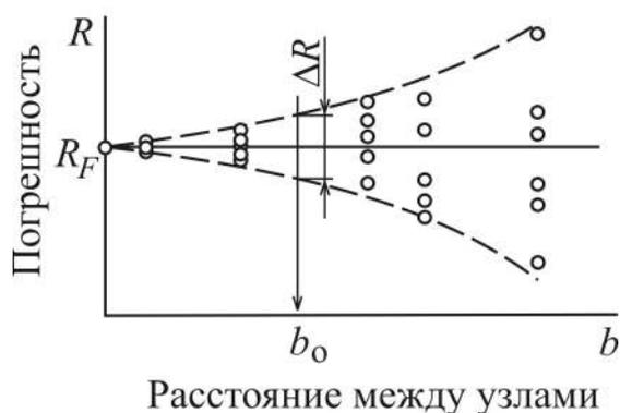
Рис. 5.3. Установление оптимального расстояния между узлами
