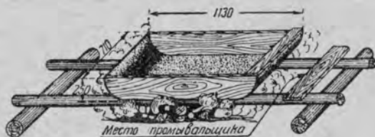
Фиг. 21. Бак для промывки проб зимой (по П. А. Харитонову)
