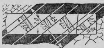
Фиг. 40. Борозды по мощности при ясных границах между слоями различной минерализации
