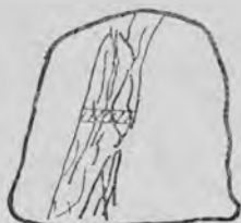
Фиг. 47. Бороздовая проба по сетчатой зоне
