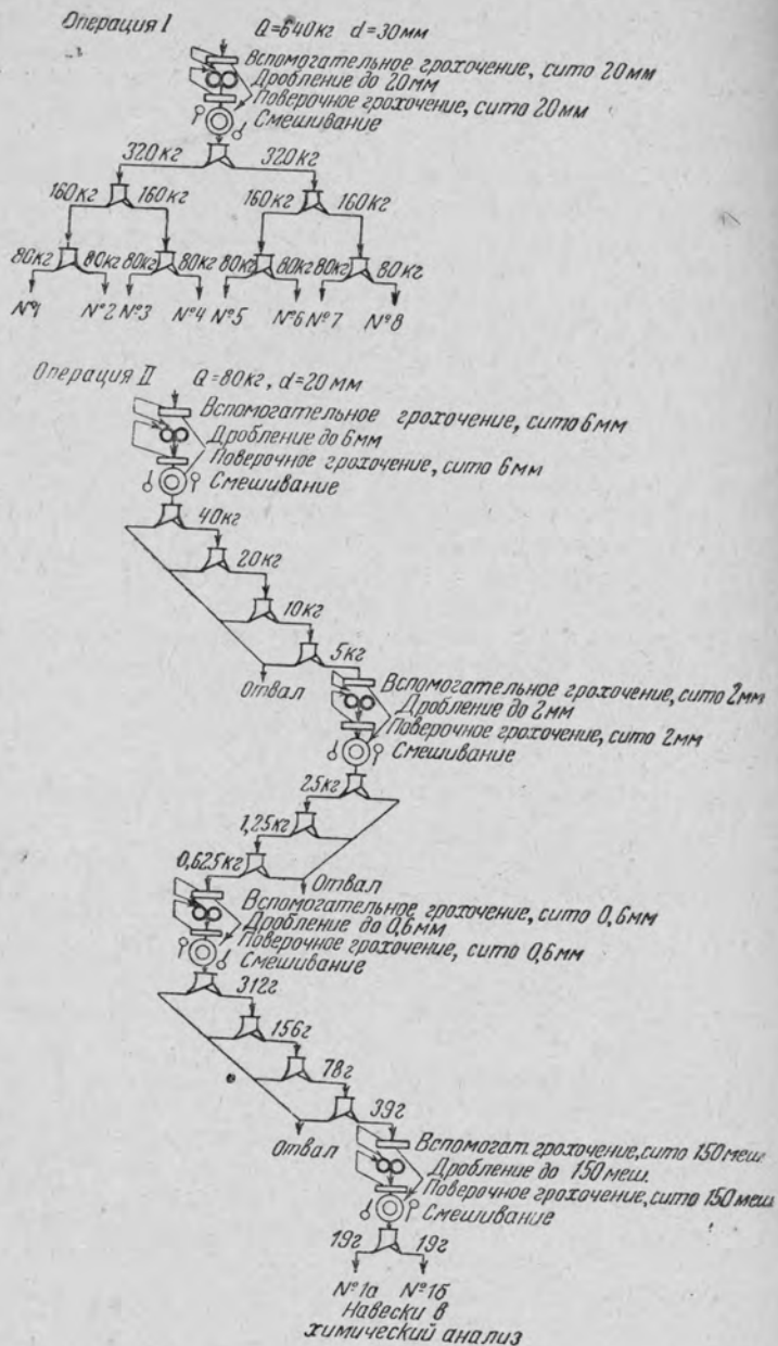
Фиг. 72. Схема обработки опытных проб Дзидинского месторождения
