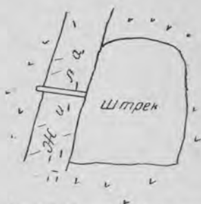
Фиг. 53. Расположение шпуров при опробовании никелевых жил Ниттис-Кумужье
