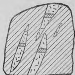
Фиг. 48. Бороздовое опробование жилы, разбитой на линзы
