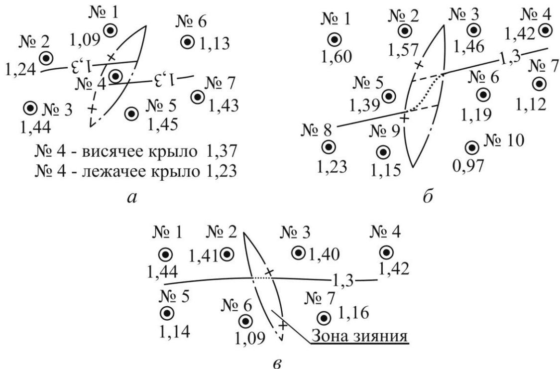
Рис. 4.8. Построение изолиний в районе разрывных нарушений
