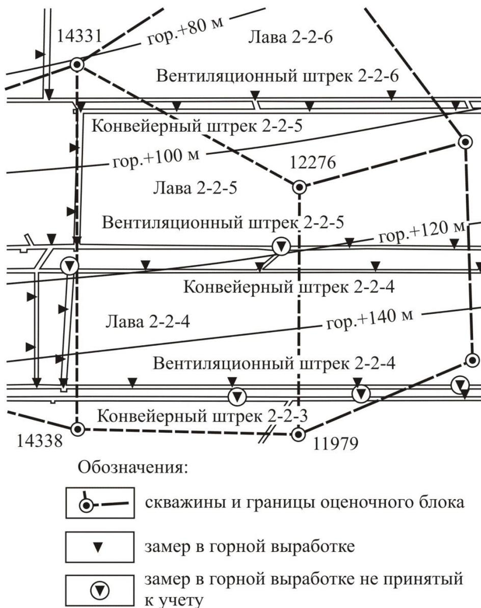
Рис. 5.7. Графические материалы для выполнения работ по оценке фактической точности горно-геометрической модели
