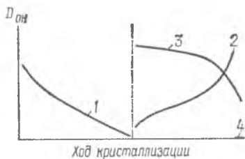
Рис. 75. Обобщенная схема изменения концентрации H^+ (выражен через коэффициент поглощения ОН-полос на ИК-спектрах) в процессе роста кристаллов кварца:
