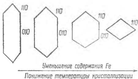
Рис. 65. Изменение морфологии грани {001} литиево-железистых слюд (протолитионит-цинвальдит) с уменьшением в них содержания железа (камерные пегматиты Волыни)
