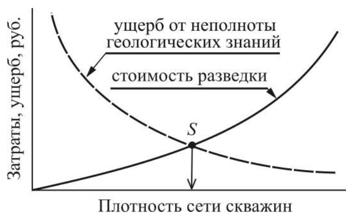
Рис. 1.1. К определению оптимальной плотности сети скважин
