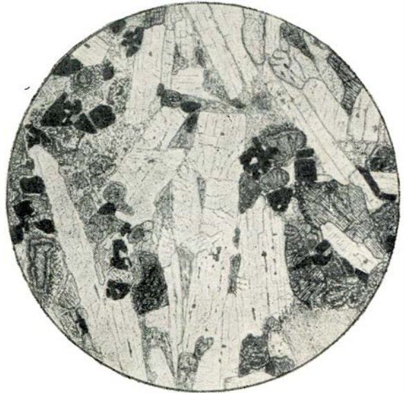
Рис. 1. Метасоматически обогащенная лабрадором ультраосновная порода. Стремигородский участок Коростеньского плутона. Без анализатора; увел. 10. (Рис. Н. П. Леонтьевой).
