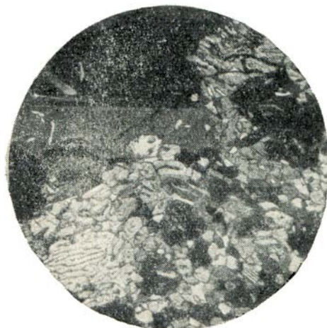
Рис. 6. Вростки кварца в сподумене. Снято с анализатором. Увел. 15.
