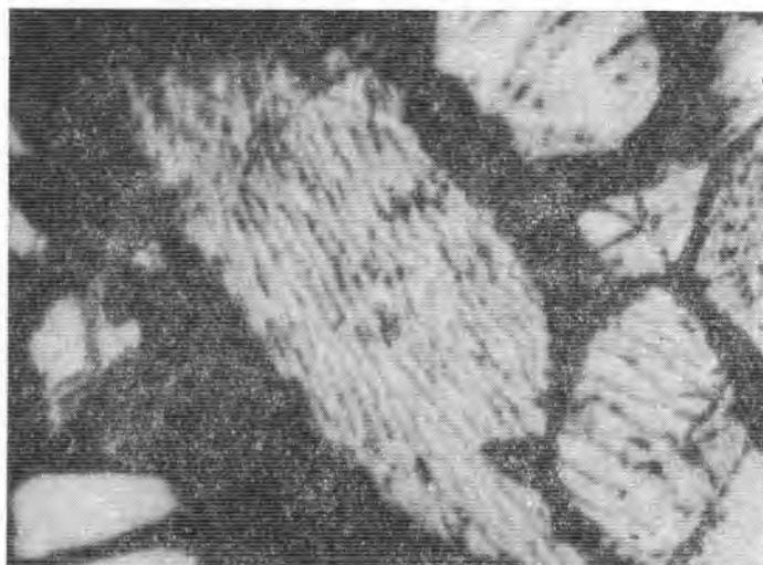
Рис. 8. Пластинчатое сложение метаморфогенного гематита, выявлено электролитическим травлением соляной кислотой при пропускании электрического тока. Отраженный свет. Без анализатора, ув. 990.
