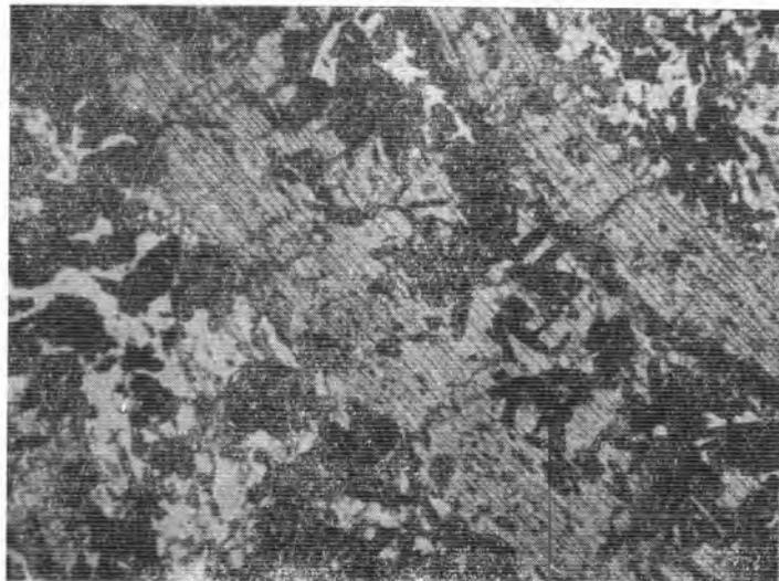
Рис. 4. Развитие пластинчатых кристаллов гематита (черное) в эгирине (светло-серое). Проходящий свет. Без анализатора, ув. 37.
