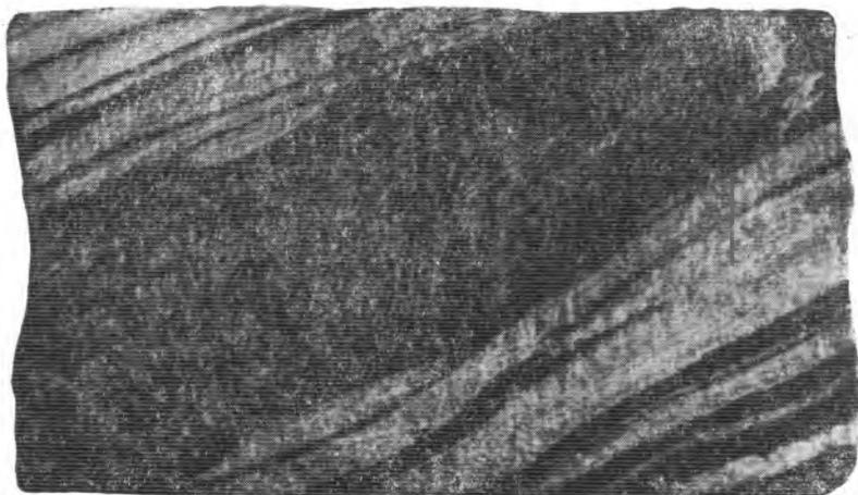
Рис. 7. Увеличение мощности рудного прослоя в месте интенсивного проявления будинажа. Фото образца керна, ум. 2.
