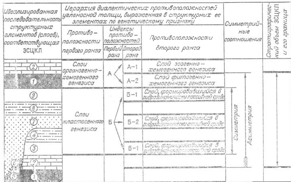
Рис. 1. Модель разреза элементарного седиментационного цикла в продуктивной толще Донбасса.
