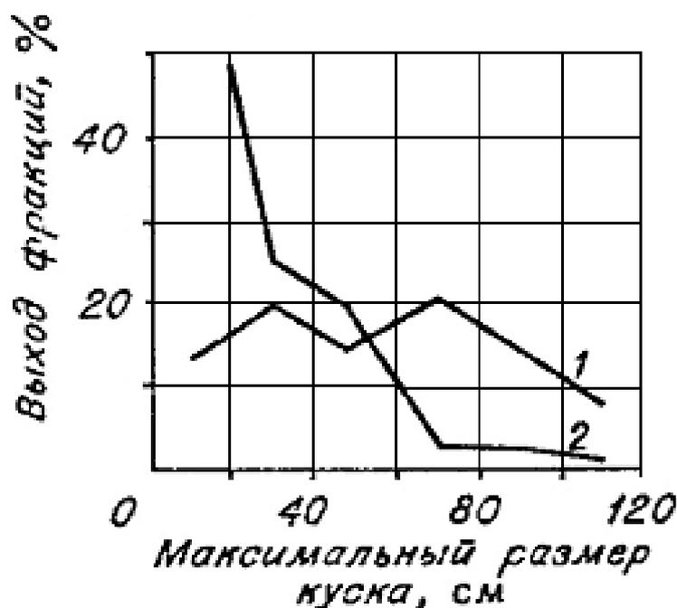
Рис. 1.1. Зависимость гранулометрического состава известняков от конструкции заряда скважин:
