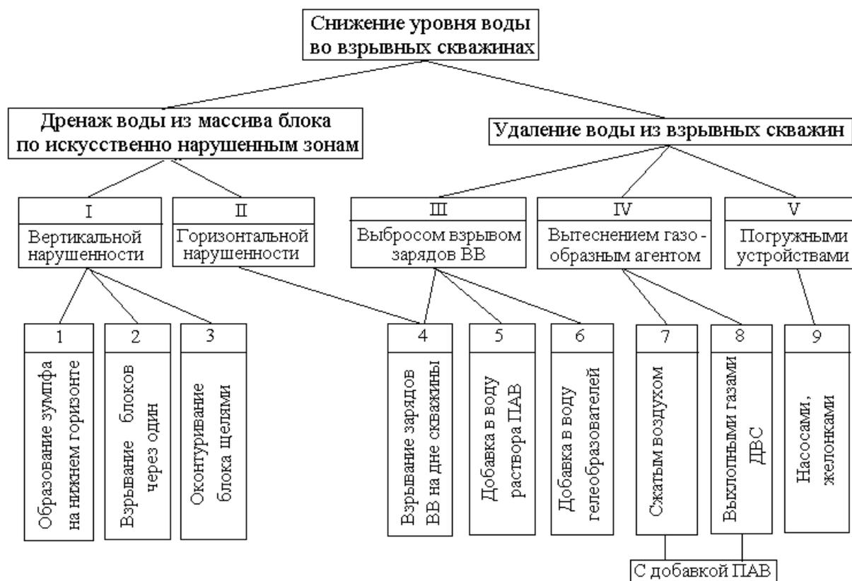
Рис. 2.5. Способы осушения скважин в горном массиве
