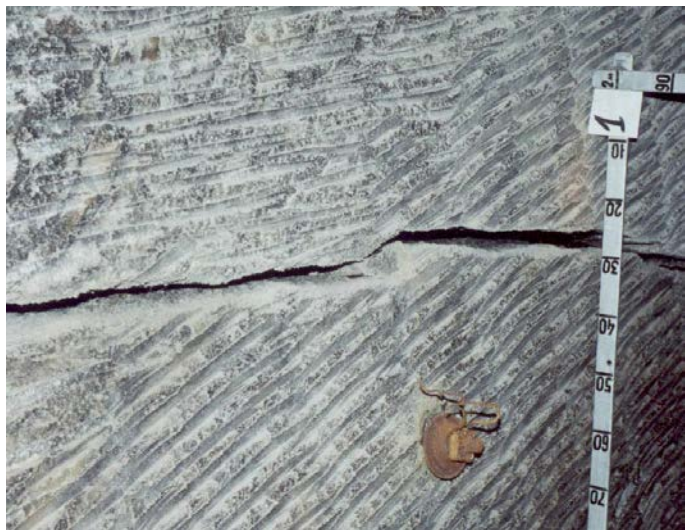
Рис. 4.17. Фрагменты трещин скола в пластах Б и Б-В. Панель 4, блок 2, западная стенка и кровля камеры № 167 в 107 м от устья (а) (фото В.А. Шабакина) и кровля камеры № 156 вблизи ее устья (б) (фото В.Е. Васюкова)
