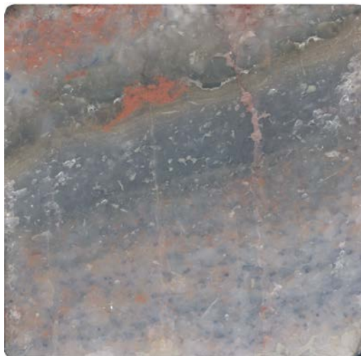
Рис. 4.21. Кливаж полосчатых сильвинитов пласта А (натур. велич.). Восточная стенка камеры № 168, в 20 м от ее устья (фото Л.В. Андрейко)
