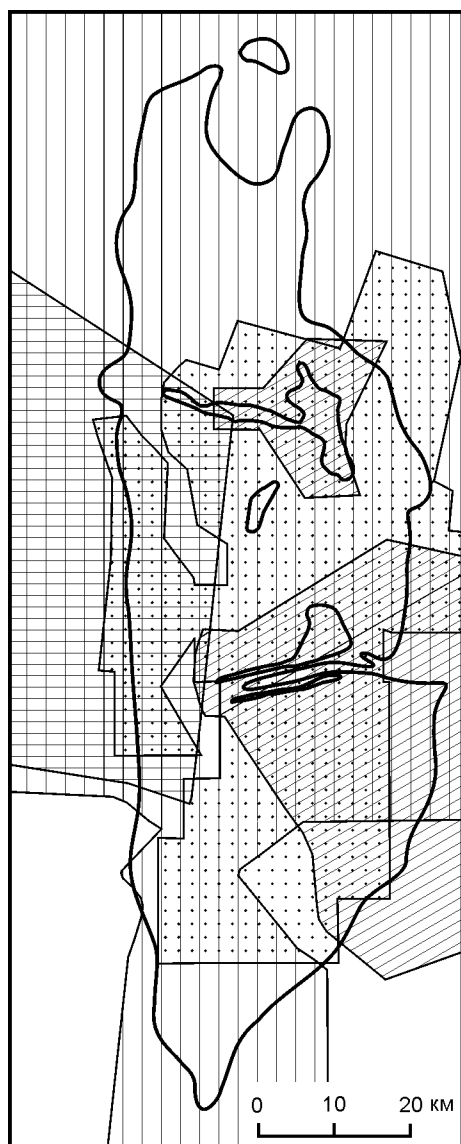
Рис. 2.2. Картограмма площадных съёмок территории ВКМС гравиметрическими методами: 1 – контур калийной залежи; масштаб изученности площади: 2 – 1:200 000 (В.Э. Голомб, 1951 г.; Е.И. Леонова, 1952 г.; Г.С. Артемьева, 1961-1962 г.); 3 – 1:100 000 (Е.К. Комаров, 1966 г.); 4 – 1:50 000 (А.Ф. Быков, 1965 г.; Б.Ю. Букин, 1966-1970 г.); 5 – 1:25 000 (Б.Ю. Букин, 1970-1971 г.; А.К. Петров, 1974-1978 г.; Л.Д. Нояксова, 1986-1989 г.)
