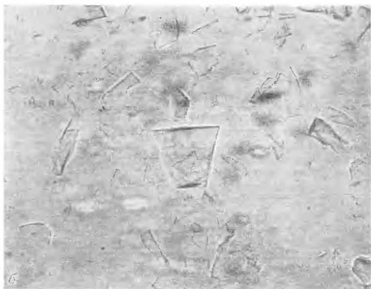
Рис. 9. Вид полоски Бекке в иммерсионном препарате ( n_k > n_{ж} ): а — столик опущен (тубус поднят); б — столик поднят (тубус опущен)
