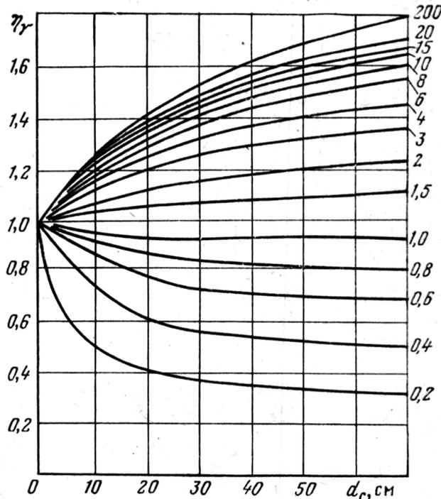
Рис. 6.5. Зависимости  $\eta$  от  $d_c$ . Шифр кривых  $q_n/q_p$ .
