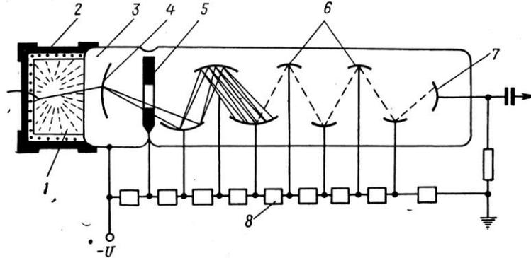
Рис. 6.1. Принципиальная схема сцинтилляционного счетчика
