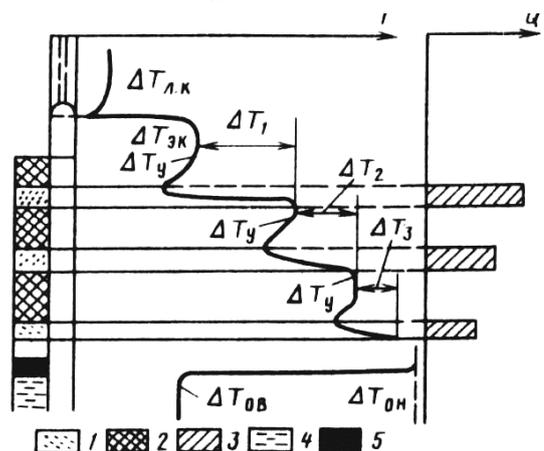
Рис. 10.5. Выделение работающих интервалов в обсаженной скважине по кривой термокондуктивного расходомера.
