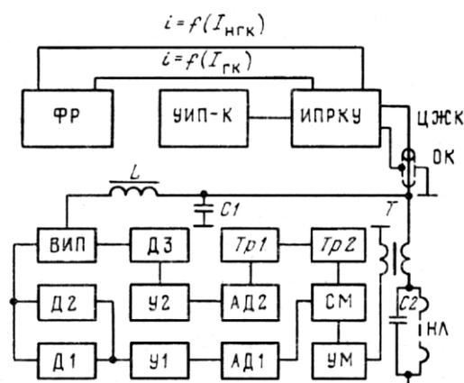
Функциональная схема скважинного прибора ДРСТ-3
