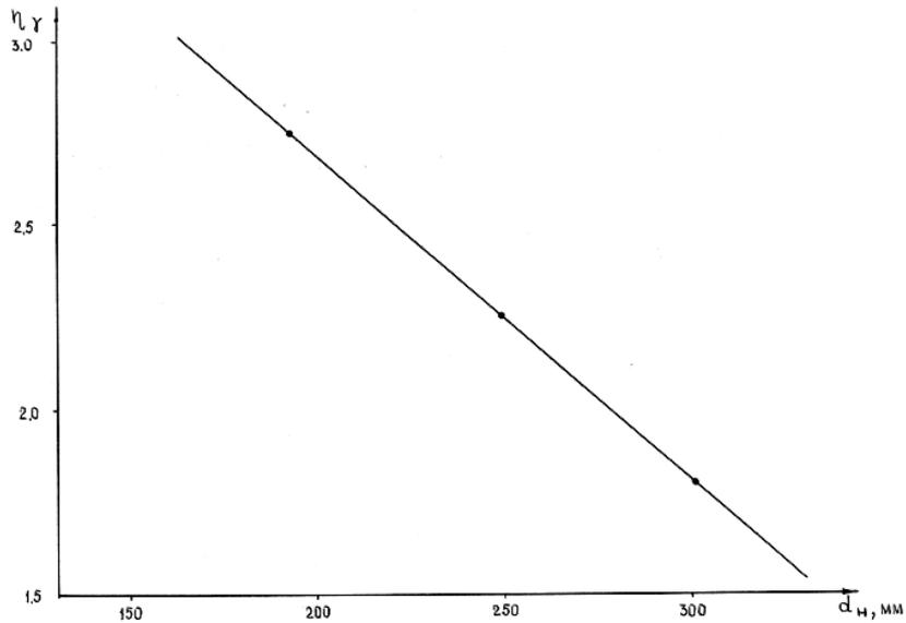
Рис. 6.8. Пример построения зависимости между  $\eta_\gamma$  и  $d_n$  при  $\delta_p=1,3 \text{ г/см}^3$  и  $d_\phi=50 \text{ см}$
