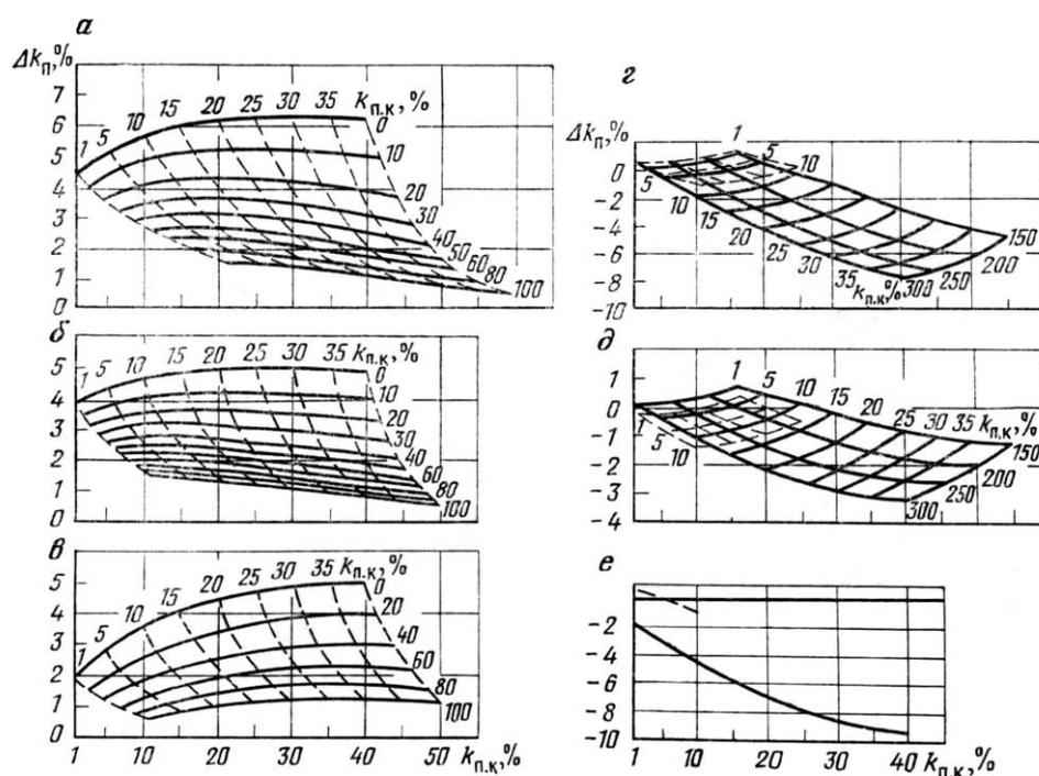
Рис. 7.4. Палетки для определения поправки  $\Delta K_p = K_{п,каж} - K_p$  за минеральный состав терригенных (а, б, в) и карбонатных (г, д, е) пород.
