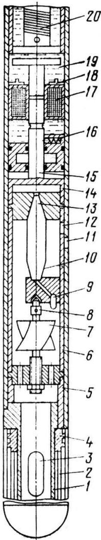
Рис. 10.2. Основные узлы преобразователя расхода и влажности ПРВС-1
