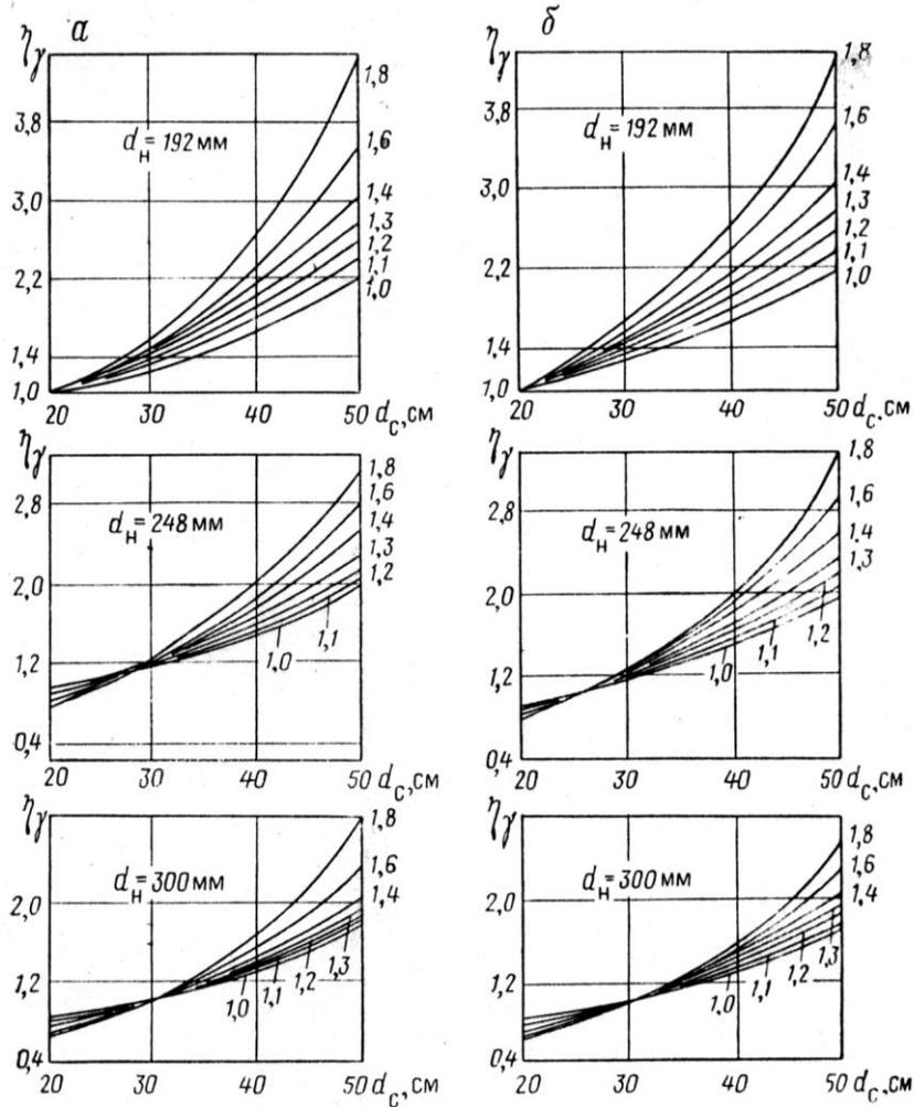
Рис. 6.6. Палетки для определения поправки  $\eta_\gamma$ , учитывающей влияние диаметра скважины  $d_c$  на показания ГМ для случая измерений в необсаженной скважине с аппаратурой диаметром 102 мм (а) и 60 мм (б).
