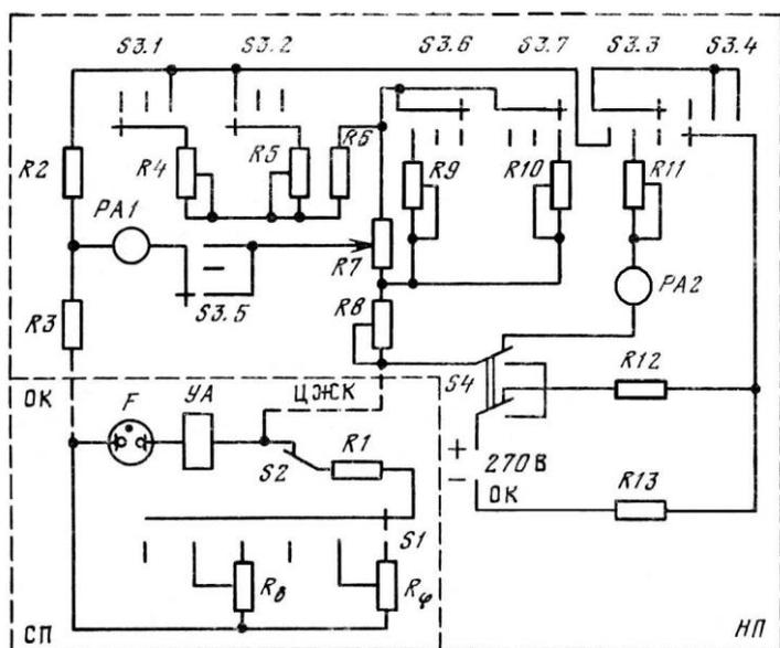
Рис. 9.2. Принципиальная электрическая схема инклинометра КИТ
