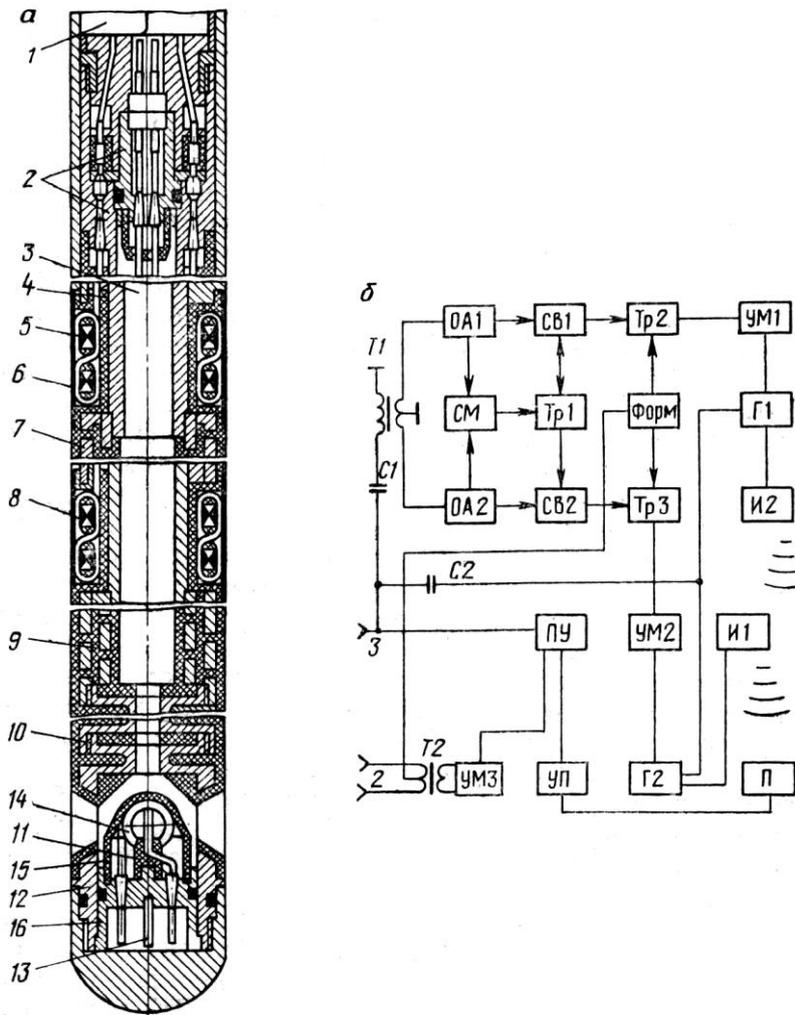
Рис. 8.3. Акустический зонд (а) и функциональная схема скважинного прибора СПАК-6 (б)
