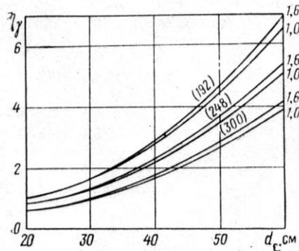
Рис. 6.7. Палетка для определения поправки  $\eta_\gamma$ , учитывающей диаметр обсаженной трубами скважины  $d_c$ .
