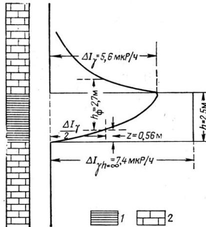
Рис. 6.3. Примерная форма аномалии на диаграмме ГМ против пласта повышенной радиоактивности (1 – глина; 2 – известняк (пласт пониженной радиоактивности))
