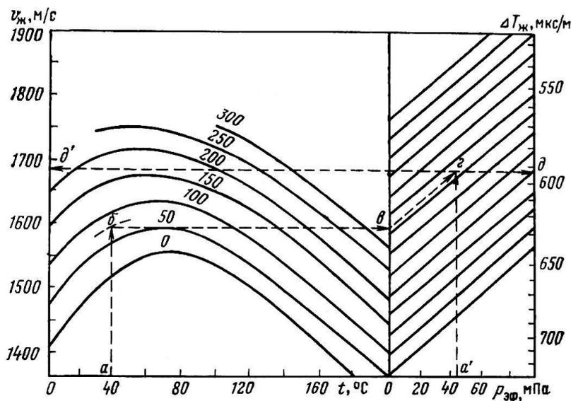
Рис. 8.6 Палетка для определения интервального времени  $\Delta T_{ж}$ , скорости  $v_{ж}$  при заданных минерализации  $C_{в}$ , давлении  $P_{эф}$ , температуре  $t$  (раствор NaCl)
