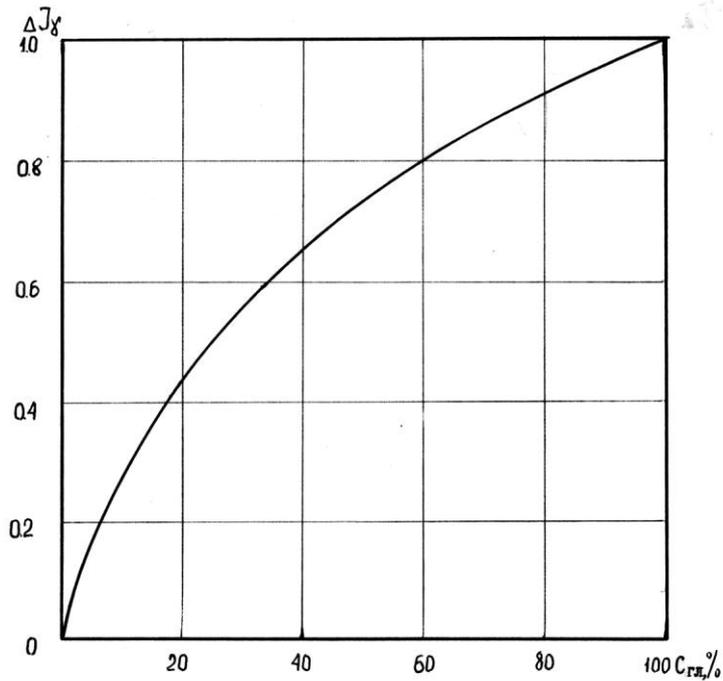
Рис. 6.9. Зависимость показаний гамма-метода в единицах относительного разностного параметра  $\Delta J_\gamma$  от глинистости горных пород  $C_{гл}$
