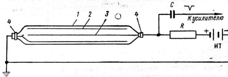
Рис. 6.2. Принципиальная схема устройства и включения газоразрядных счетчиков
