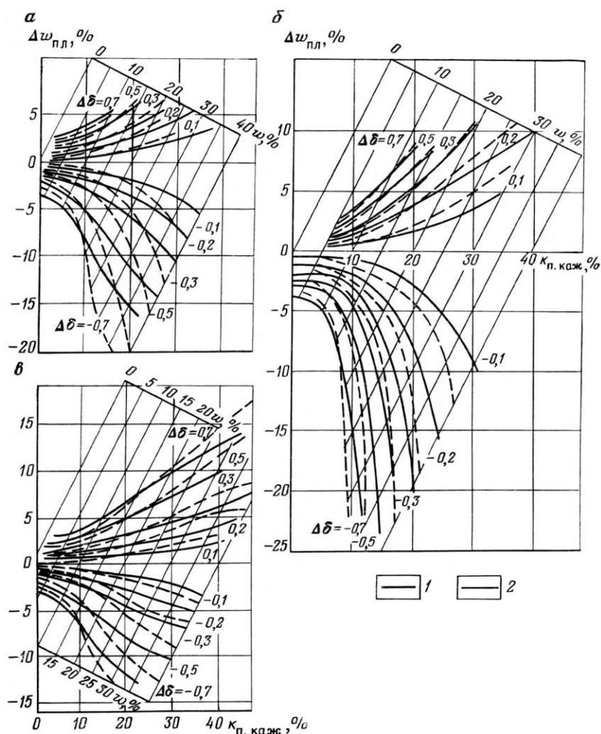
Рис. 7.5. Палетки для определения поправки за плотностный эффект  $\Delta w_{\text{пл}}$  по водородному индексу пласта  $w$  и кажущейся пористости (по СНМ)  $K_{\text{п. каж}}$ .
