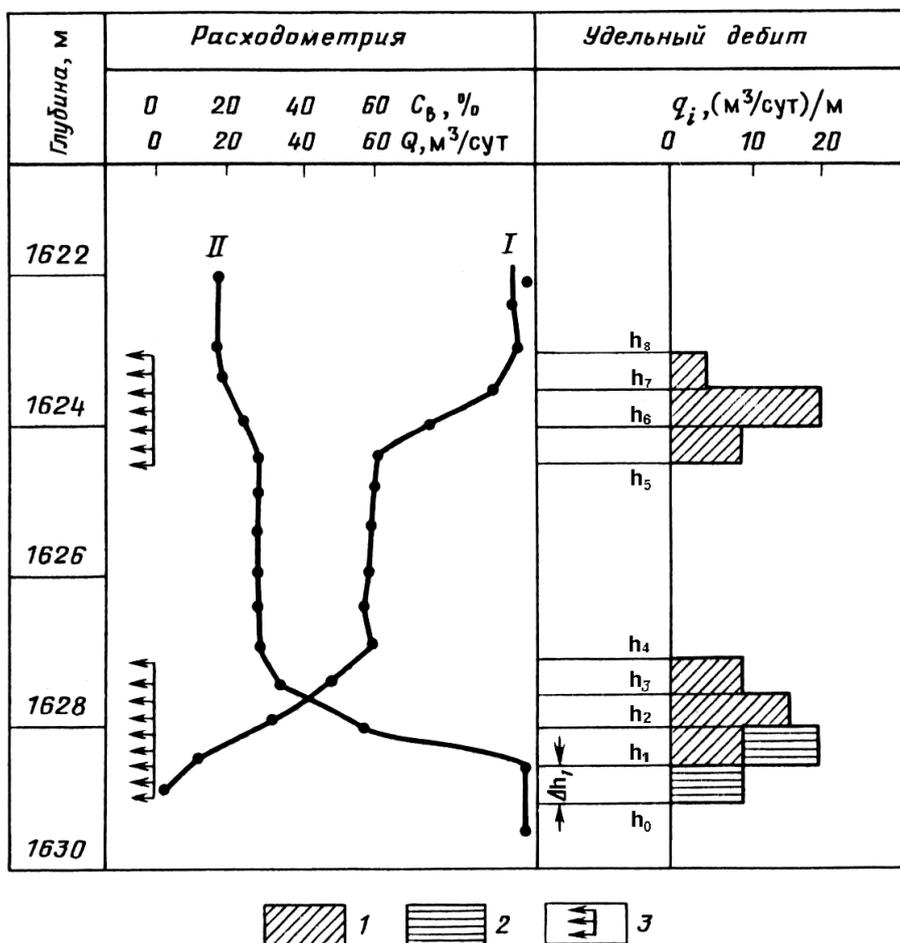
Рис. 10.4. Пример обработки показаний механического расходомера и влагомера.
