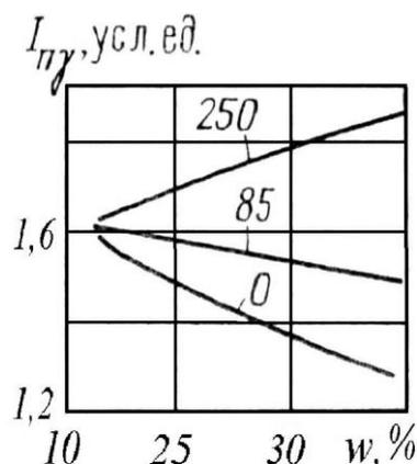
Рис. 7.1. Кривые  $I_{ny}=f(w)$ , полученные на моделях среды в условиях повышенной минерализации пластовых вод.
