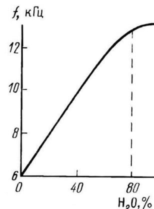
Рис. 10.1. Эталонировочный график зависимости показаний влагомера  $f$  от содержания воды в смеси
