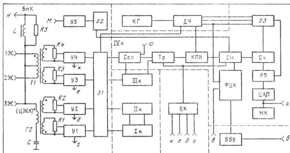
Рис. 7.3. Функциональная схема измерительного пульта ИПРКУ-А
