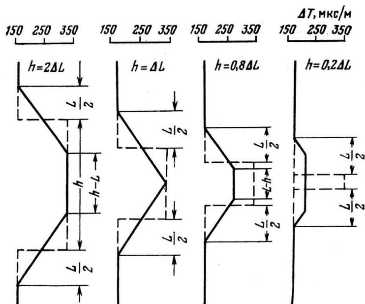
Рис. 8.4 Теоретические формы аномалий и определение границ пластов по диаграммам акустического зонда.  $\Delta L = L_2 - L_1$  – расстояние между приемниками (база зонда)
