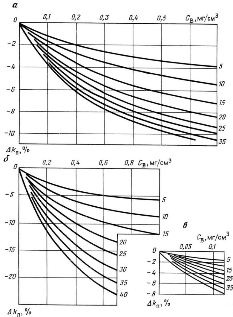
Рис. 7.7. Палетки для определения поправки  $\Delta K_{п}$  за влияние примеси бора на результаты НГМ-Т-50 (а), НГМ-60 (б, в) с аппаратурой ДРСТ-3 и СП-62.
