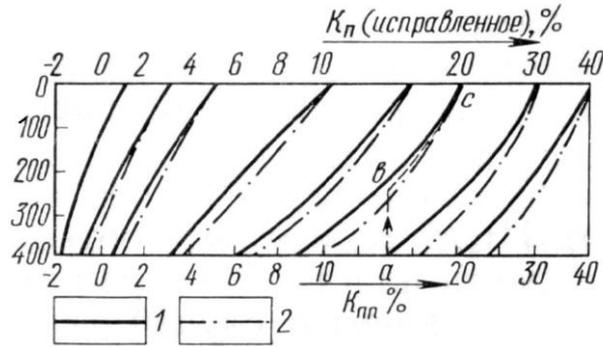
Рис. 7.8. Палетки для учета температуры водонасыщенного пласта  $T_{пл}$  и скважины  $T_c$  при  $T_c=T_{пл}$  (прибор эталонирован при нормальной температуре; НГМ;  $d_c = 190$  мм.
