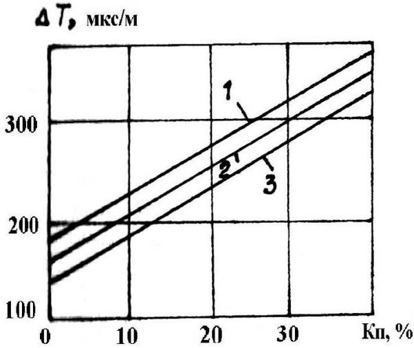
Рис.8.5 Зависимости интервального времени  $\Delta T$  от коэффициента пористости  $K_{п}$  для песчаников (1), известняков (2) и доломитов (3) при атмосферных условиях
