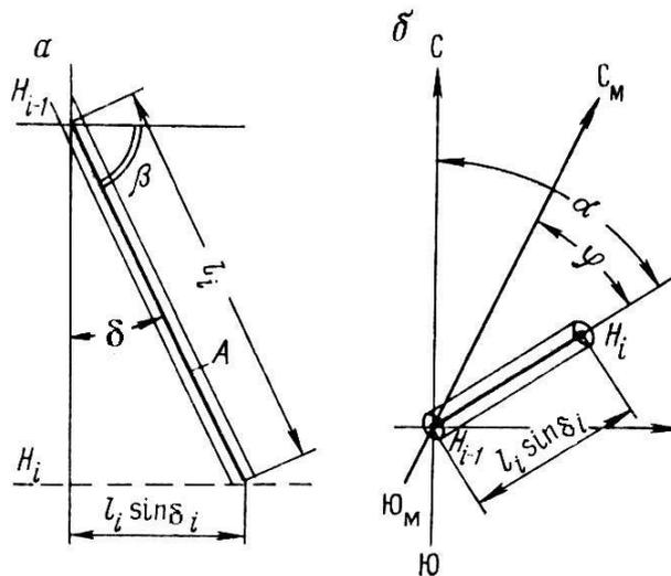
Рис. 9.3. Участок оси скважины в вертикальной плоскости (а) и проекция участка ствола скважины на горизонтальную плоскость (б).
