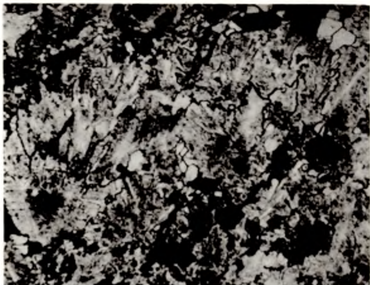
Рис. 40. Сложноузорчатая метаколлоидная структура пиритового агрегата в оолите. Полиров. шлиф, увел. 180. Няльмозерское месторождение.
