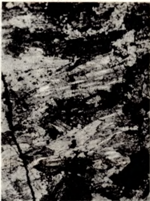
Рис. 38. Радиально-лучистая структура отдельных зон оолитов. Полиров. шлиф, увел. 180. Мулдусельгское месторождение.
