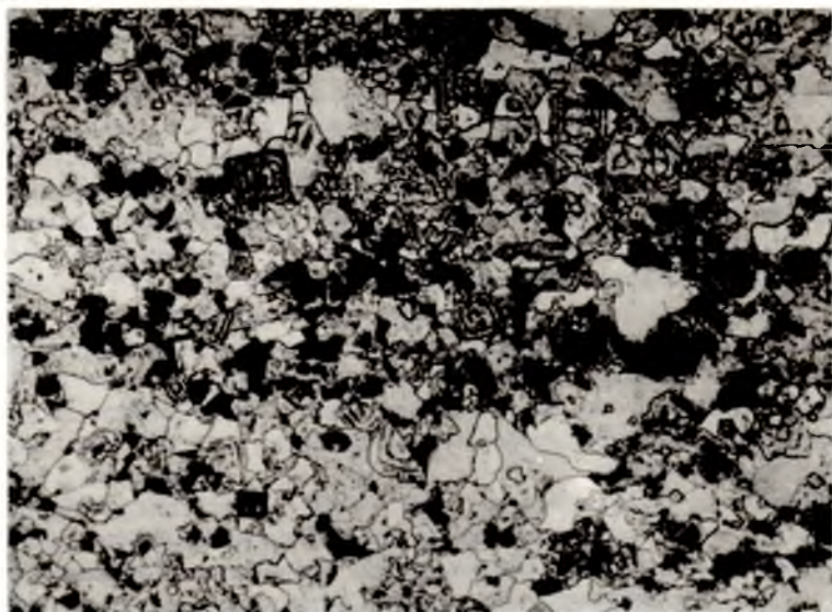
Рис. 41. Реликты зональных кристаллов пирита в раскристаллизованном пиритовом агрегате. Полир. шлиф, увел. 58,5. Няльмозерское месторождение.
