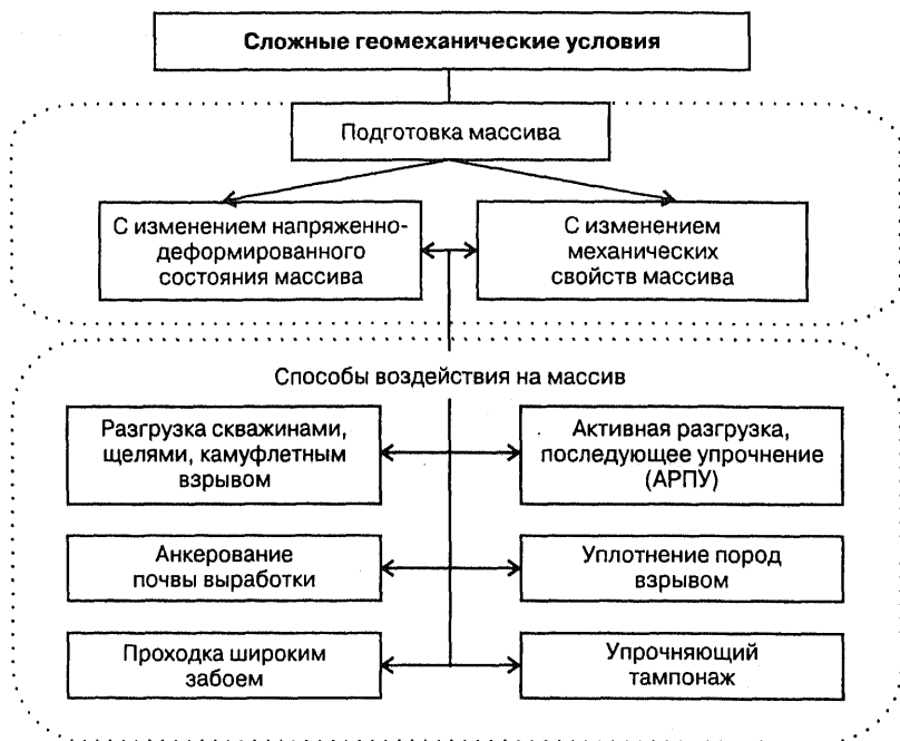
Рис. 2.3. Способы подготовки и воздействия на массив горных пород при строительстве подземных сооружений в сложных геомеханических условиях
