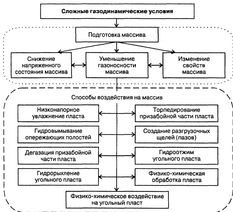
Рис. 2.2. Способы подготовки и воздействия на массив горных пород при строительстве подземных сооружений в сложных газодинамических условиях
