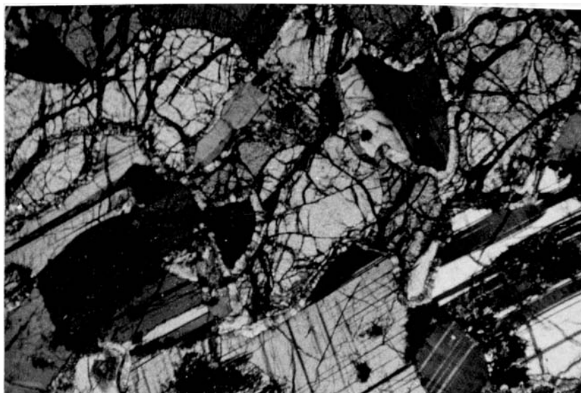
Рис. 6.99. Реакционная каемка тремолит-актинолита вокруг оливина в троктолите. Увел. 20, николи +
