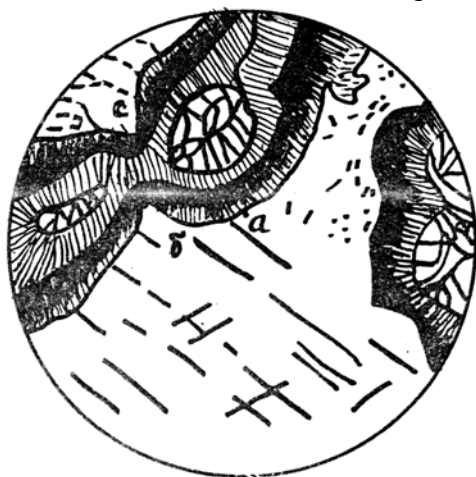
Рис. 6.102. Друзитовая структура (а – оливин; б – пироксен; с – амфибол)
