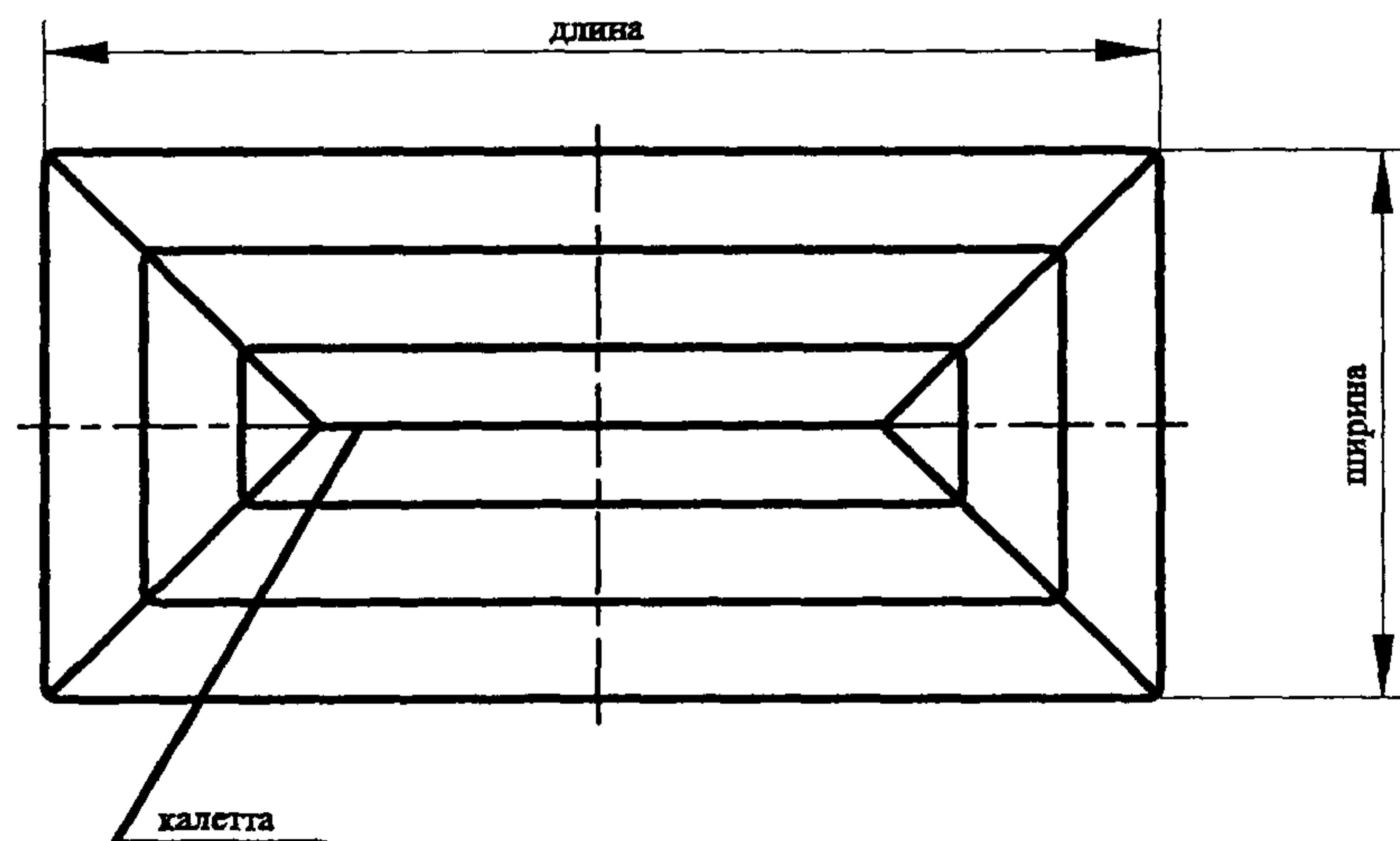
Обозначение линейных размеров элементов фасетной огранки
