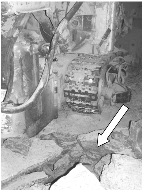
Рис. 2. Разрушение пород почвы, сопровождающееся газовыделением
